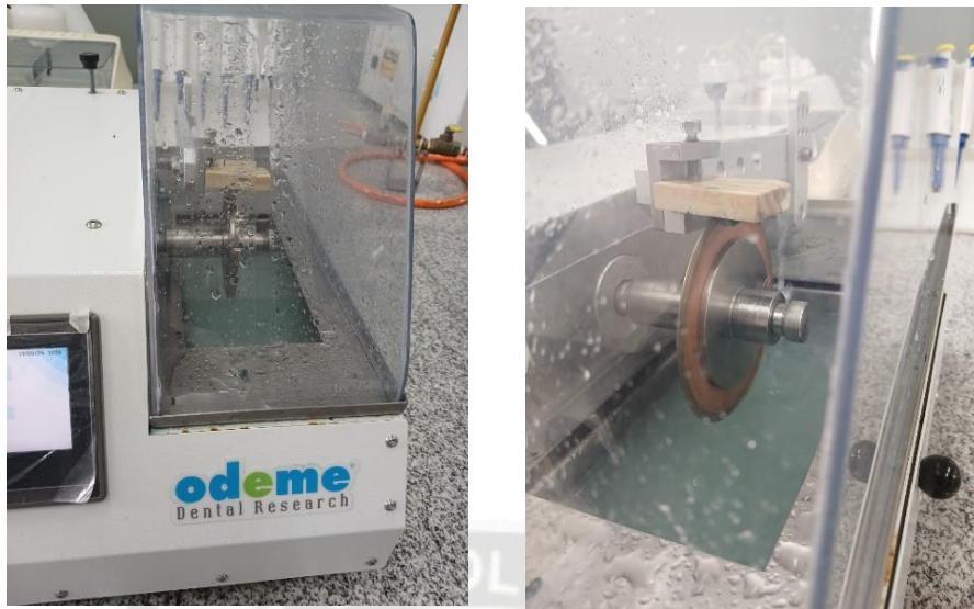
Figura 11: Máquina de corte de tejidos duros
