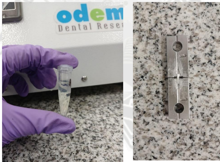
Figura 12 y 13: Especímenes de resina-adhesivo-dentina y fijación en Jig (Microntensile JIG2 Compact; Odeme, Luzerna, SC, BR)
