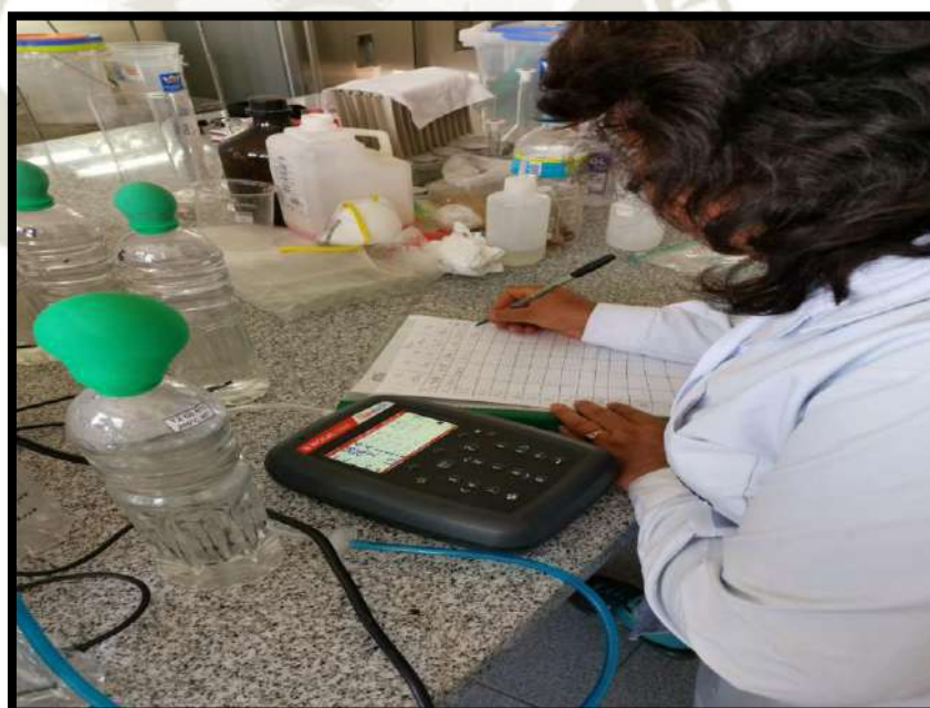
Figura 36. Registro de la medida de la calidad del biogás con el analizador.
