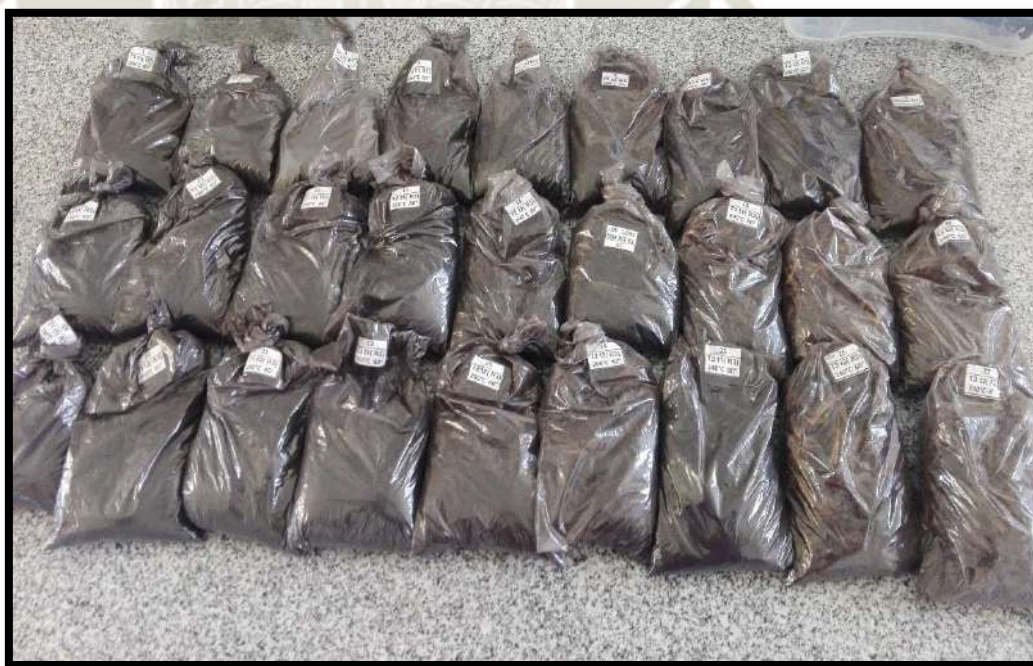
Figura 23. Biomasa de residuos de poda de uva torrefactados y molidos.
