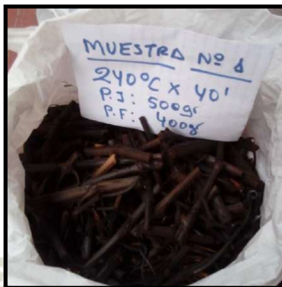
Figura 20. Rendimiento masico después de la torrefacción.
