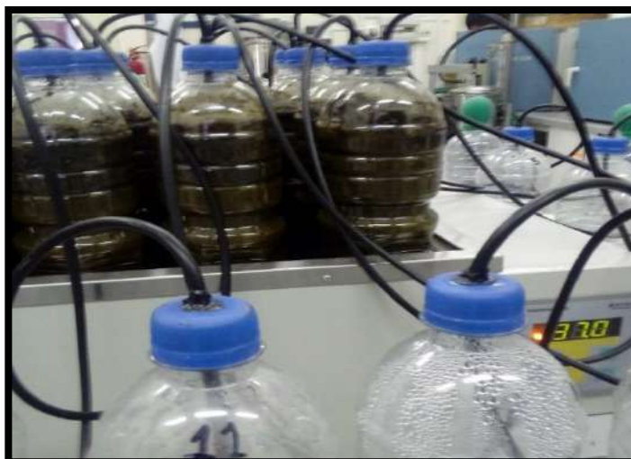
Figura 31. Proceso de biodigestión en baño maría a temperatura de 37°C.
