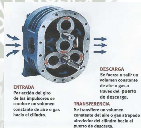
Ilustración 30: Corte lateral de Soplador lobular
