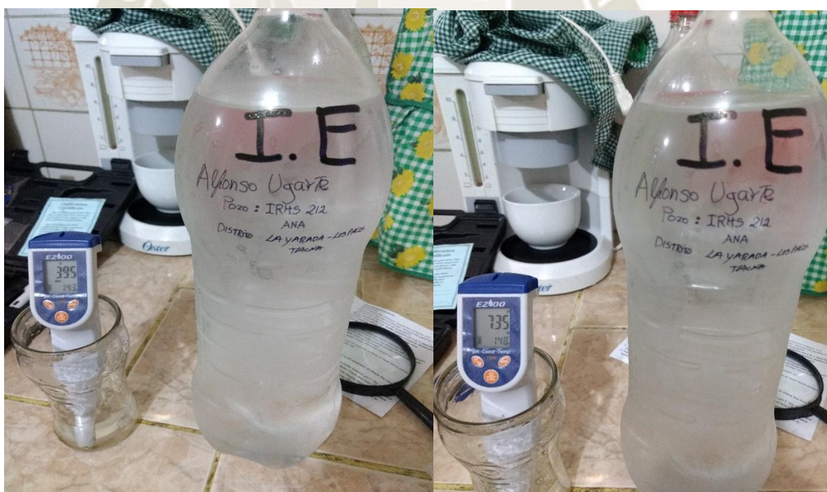
PRUEBA DE PH Y CONDUCTIVIDAD DE LA MUESTRA DEL COLEGIO POZO IRHS 212
