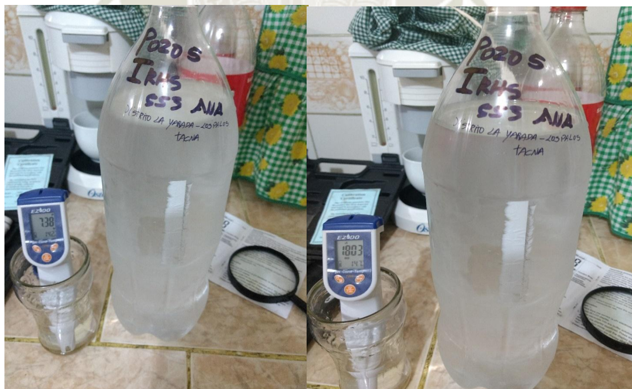
PRUEBA DE PH Y CONDUCTIVIDAD DE LA MUESTRA DEL POZO 5 IRHS 553
