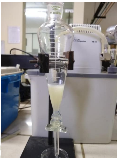
Figura 2.5: Separación de la fase lipídica de la muestra con hexano, para su posterior eliminación.
