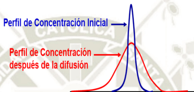
Figura 1.8: Factores que causan el ensanchamiento de banda: Difusión longitudinal.
