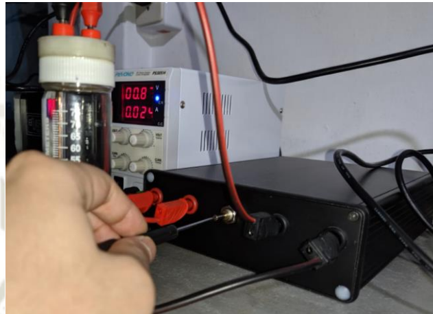
Figura 4.5. Calibración de puente de Wheatstone Fuente: Elaboración propia
