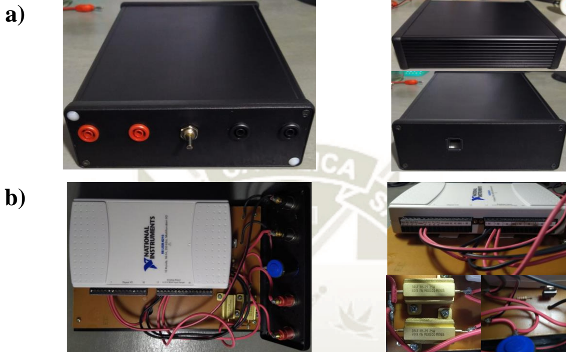
Figura 5.2. Presentación del módulo fabricado a Vista exterior: Caja de aluminio y bornes de conexión b Vista interna: Tarjeta de adquisición de datos, componentes electrónicos y cableado Fuente: Elaboración propia
