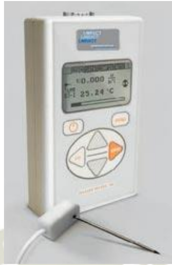
Figura 2.1. Instrumento KD2 Pro – Medidor de conductividad térmica Fuente: Decagon Devices Inc.
