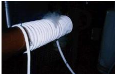
Figura 2-17: Formación de hielo alrededor de tubo de cobre que transporta LN 2
