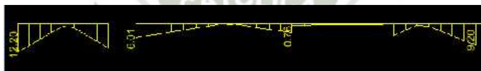
Figura 9: Diagramas de momento flector en vigas
