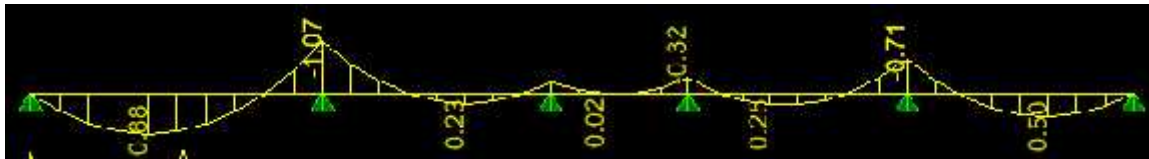
Figura 13: Diagrama de momentos en viguetas de losa
