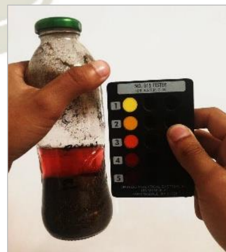
Figura 3.30. Impureza orgánica de la cantera “Chiguata”
