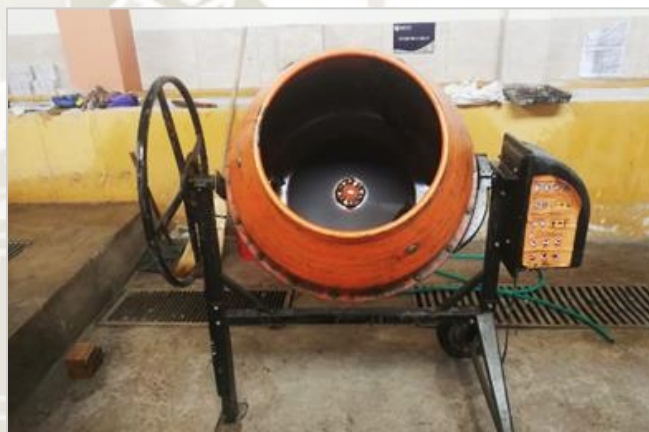
Figura 2.13. Mezcladora estacionaria de 7 p³
