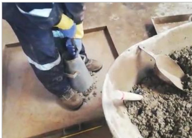
Figura 2.21. Realizando el ensayo de asentamiento Fuente: Elaboración propia, 2019.
