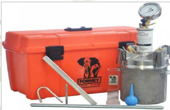
Figura 2.22. Equipo de olla de Washington
