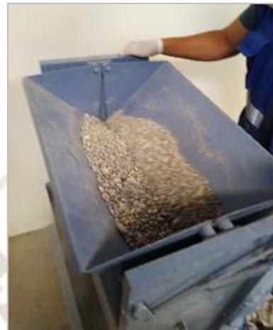
Figura 3.3. Reducción de muestra por cuarteo mecánico
