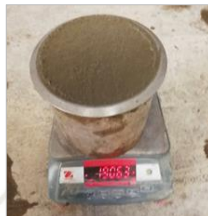
Figura 2.24. Pesando el recipiente lleno de concreto
