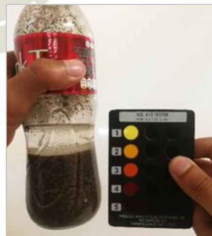
Figura 3.26. Impureza orgánica de la cantera “La Poderosa”
