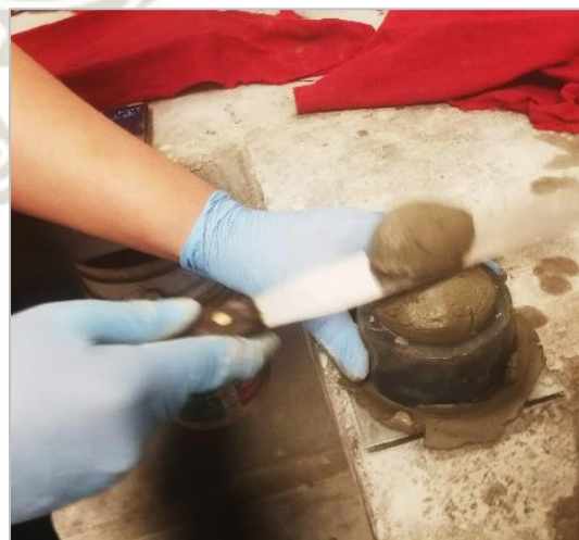
Figura 3.37. Eliminando exceso de pasta del molde Fuente: Elaboración propia, 2019.
