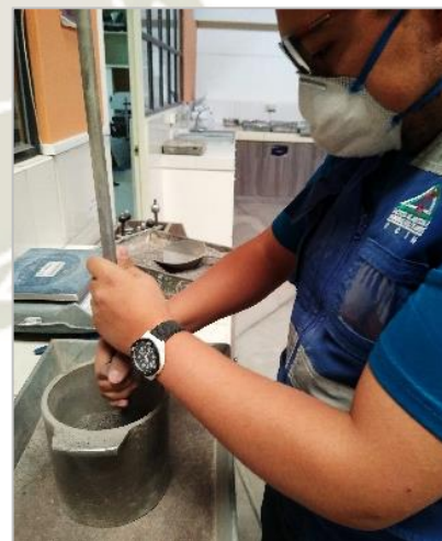
Figura 3.12. Compactando la primera capa de muestra
