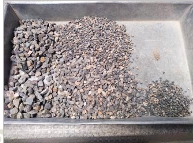
Figura 3.7. Agregado grueso “Chiguata” distribuido por tamaño
