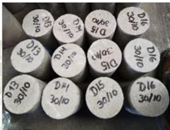
Figura 2.17. Probetas desmoldadas y rotuladas
