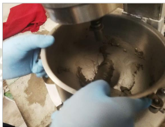
Figura 3.35. Cemento siendo mezclado con agua Fuente: Elaboración propia, 2019.
