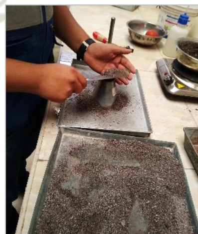
Figura 3.14. Llenando el cono con la muestra
