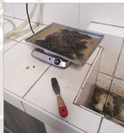
Figura 3.13. Muestra en estufa
