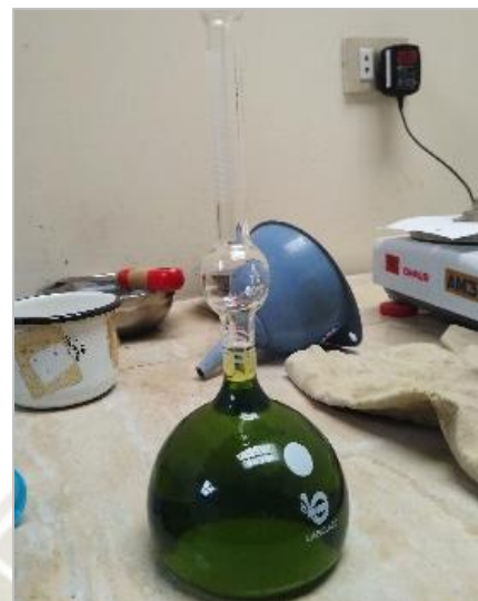
Figura 3.33. Frasco “Le Chatelier” con petróleo para la lectura inicial
