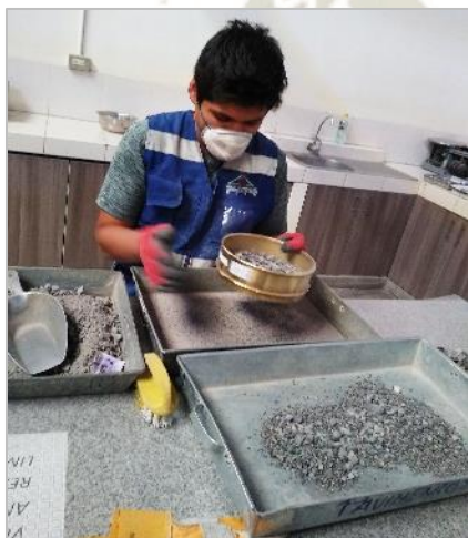
Figura 3.24. Tamizando muestra obtenida por el tamiz N°12 luego del ensayo de Abrasión.
