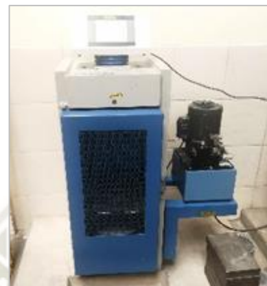
Figura 2.26. Máquina de compresión axial
