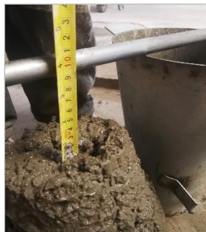
Figura 2.20. Tomando medida al asentamiento del concreto Fuente: Elaboración propia, 2019.
