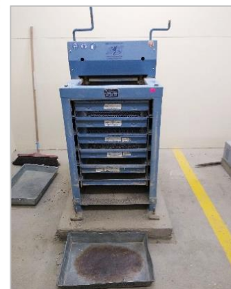
Figura 3.6. Tamizador mecánico de agregado grueso
