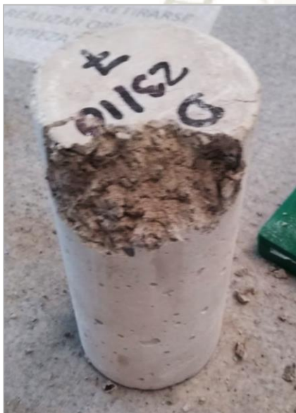
Figura 5.2. Compresión a 7 días, muestra falla en el borde de la parte superior Fuente: Elaboración propia, 2019.
