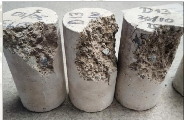
Figura 5.1. Compresión a 28 días, presenta falla vertical hasta la mitad formando un cono en la base inferior Fuente: Elaboración propia, 2019.
