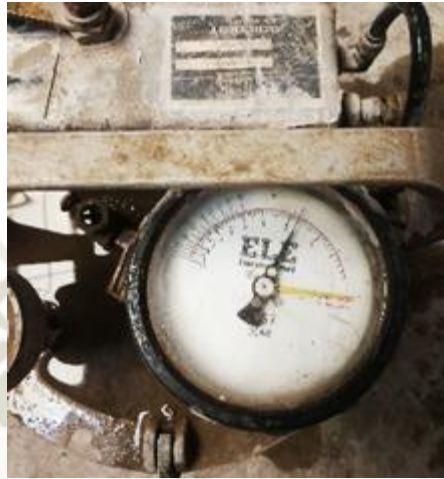
Figura 2.23. Tomando medida al contenido de aire del concreto
