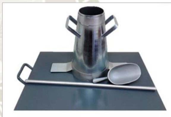
Figura 2.19. Cono de Abrams, base, varilla compactadora y cucharón
