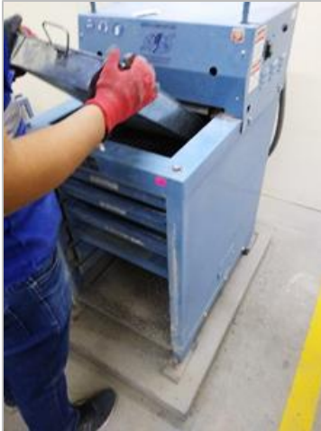
Figura 3.8. Vertiendo el agregado grueso en el tamizador
