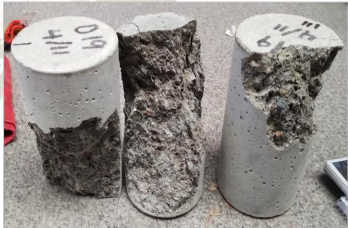
Figura 5.3. Compresión a 28 días, falla de manera vertical que atraviesa toda la probeta Fuente: Elaboración propia, 2019.
