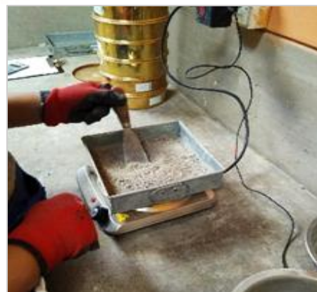
Figura 2.14. Proceso de secado del agregado fino en la estufa
