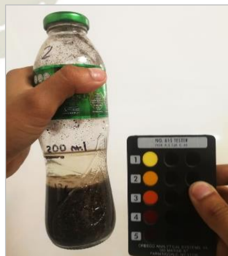
Figura 3.28. Impureza orgánica de la cantera “Huayco”
