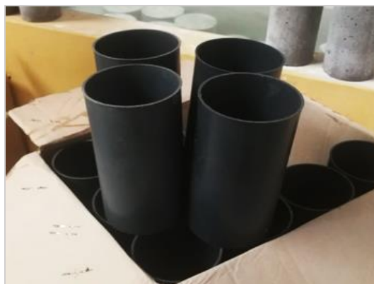
Figura 2.12. Moldes cilíndricos de plástico de 4" de diámetro y 8" de alto
