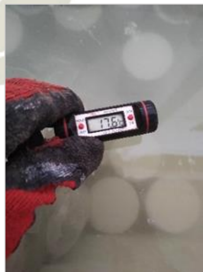
Figura 2.18. Tomando lectura de la temperatura de la cámara de curado
