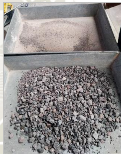
Figura 3.25. Arriba: muestra pasante del tamiz N° 12.
