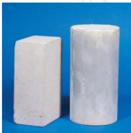
Figura 2.1. Piedra de Isla de Portland junto con una probeta de concreto
