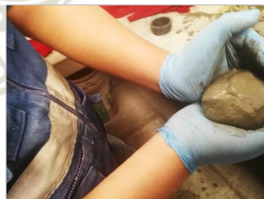
Figura 3.36. Formando la esfera de la pasta de cemento obtenida
