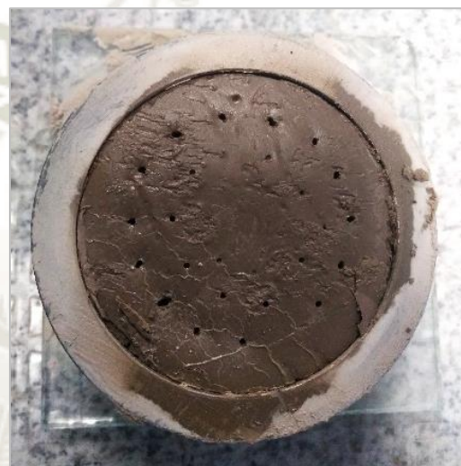
Figura 3.38. Muestra de cemento Yura IP terminadas las penetraciones con la aguja de Vicat
