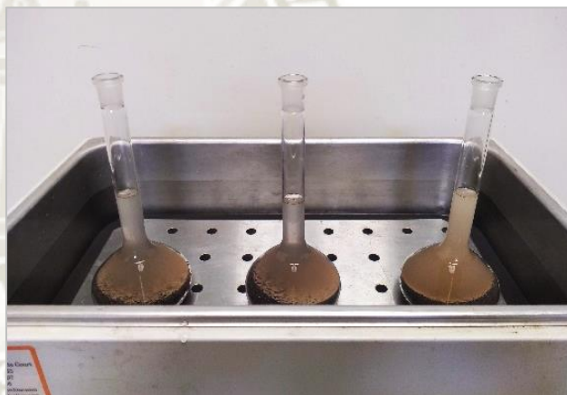
Figura 3.18. Muestras dentro del baño termorregulador
