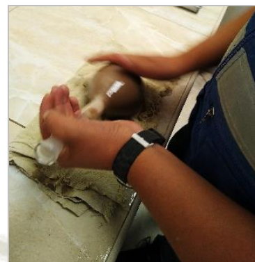
Figura 3.17. Girando el picnómetro para eliminar el aire atrapado
