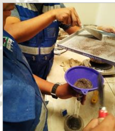
Figura 3.16. Llenando el picnómetro con la muestra preparada
