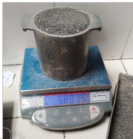
Figura 3.11. Obteniendo la masa del recipiente lleno con la muestra
