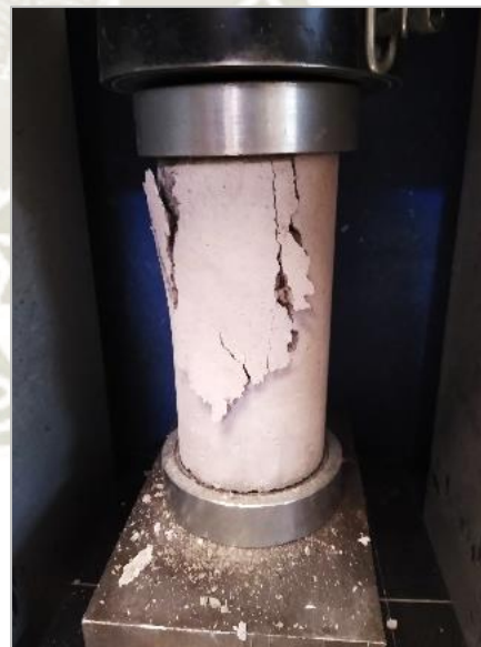
Figura 2.28. Testigo cuando llegó a su compresión máxima
