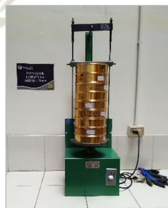
Figura 3.4. Tamizador portátil de finos con los tamices montados
