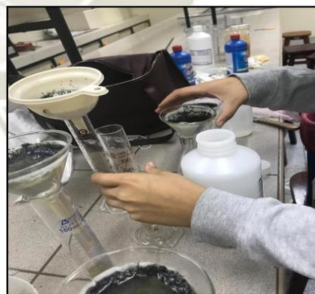
*Figura 27 Fotografías del POA Foto-Fenton, G: Después de la agitación, muestras color café rojizo, H: Reposo durante 1 hora de la muestra, I: Filtración con papel filtro, J: Muestra obtenida color amarillo, K: Añado de Cloro para regular el pH y mejorar el POA, L: Filtración utilizando Carbón Activado*
