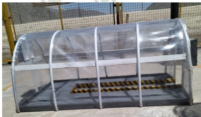
Figura 5. Construcción del desecador solar
