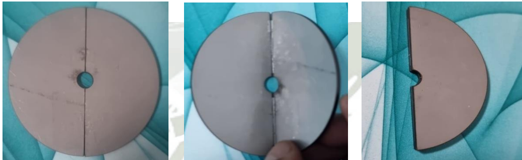
FIGURA 1. Matriz de acero inoxidable de 3" x 8mm x 2mm
