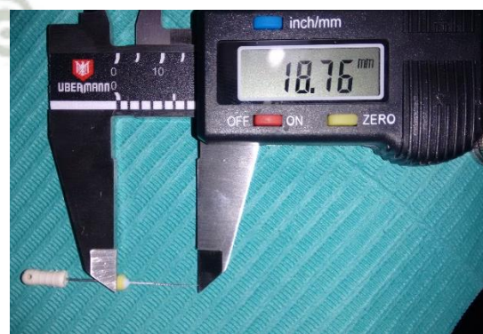
Figura 6. Medición de la lima "Longitud foramen"
