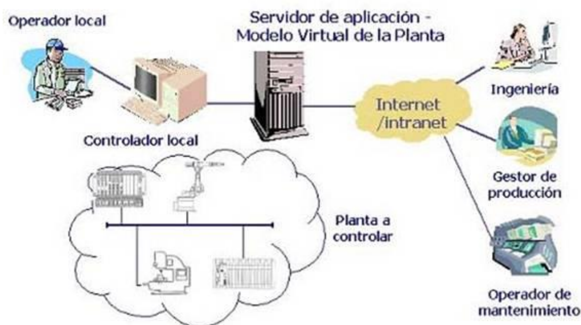
Fig. 2.38 Sistema SCADA en configuración de Lazo Abierto
