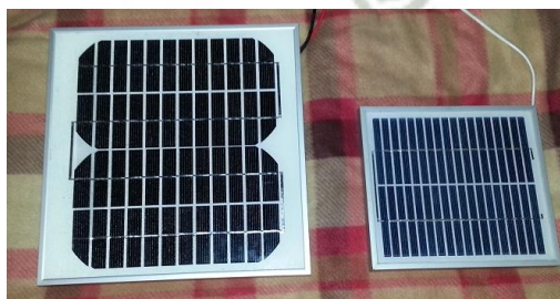
Fig. 3.25 A la izquierda panel de 10W y a la derecha panel de 3W
