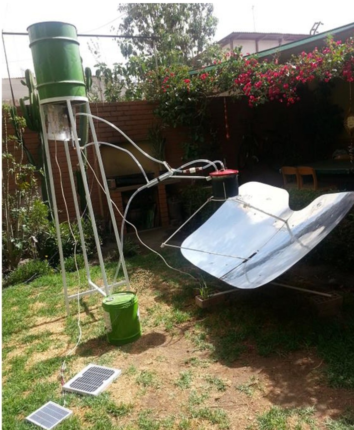
Fig. 3.83 Sistema Completo de purificación de Agua por destilación
