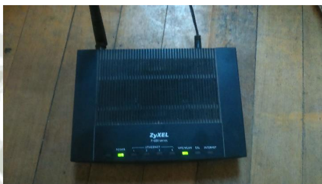
Fig. 3.38 ROUTER ZYXEL P-600 series para la conexión Ethernet y propagación inalámbrica de los datos del Sistema
