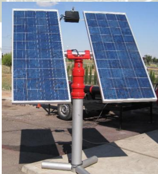
Fig. 2.25 Panel solar con seguimiento en 2 ejes
