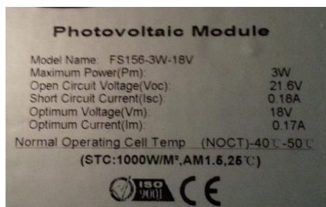
Fig. 3.26 Panel de 3W especificaciones técnicas del reverso
