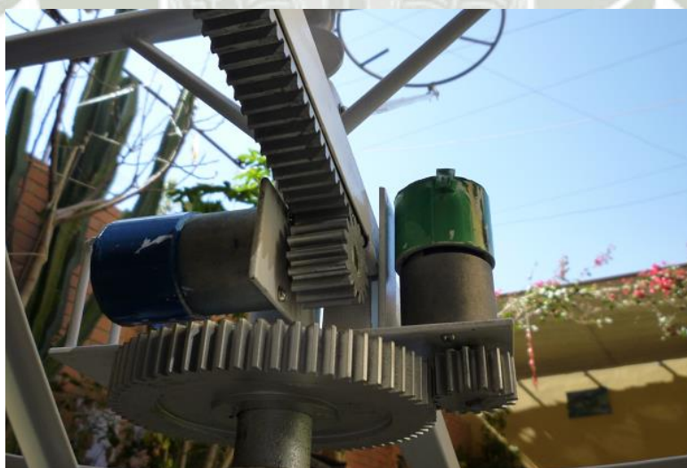
Fig. 3.9 Disposición de los motores y engranajes para los 2 grados de libertad
