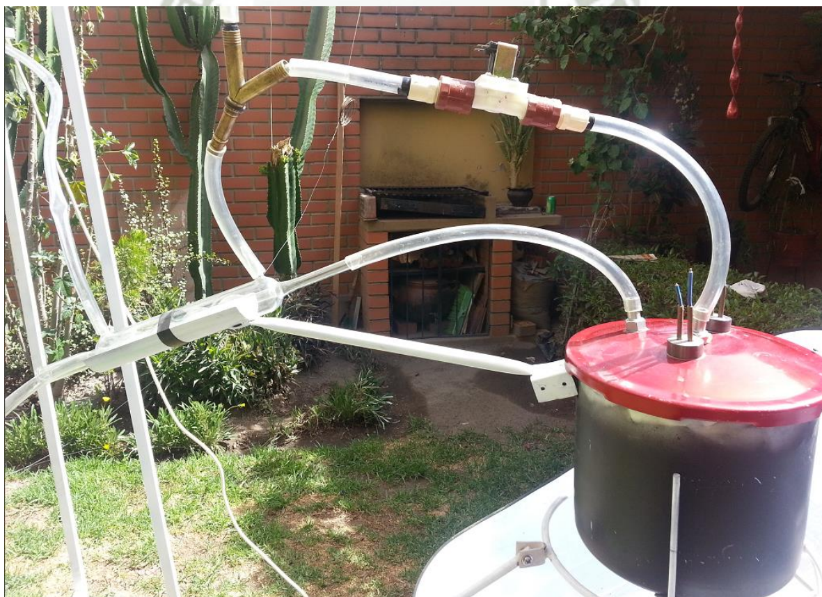
Fig. 3.82 Sistema de Condensación de Agua a utilizar
