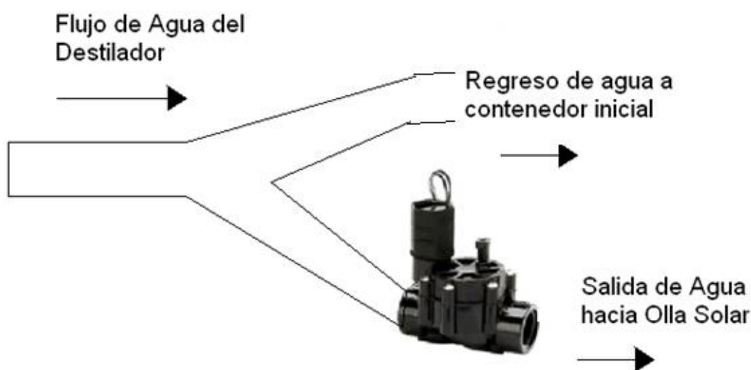
Fig. 3.80 Tubería Y para distribución del Agua a la salida del Destilador
