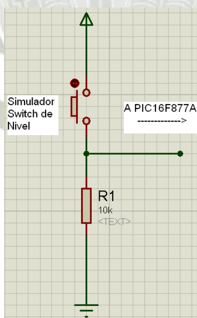
Fig. 3.76 Circuito Transductor del Sensor de Nivel
