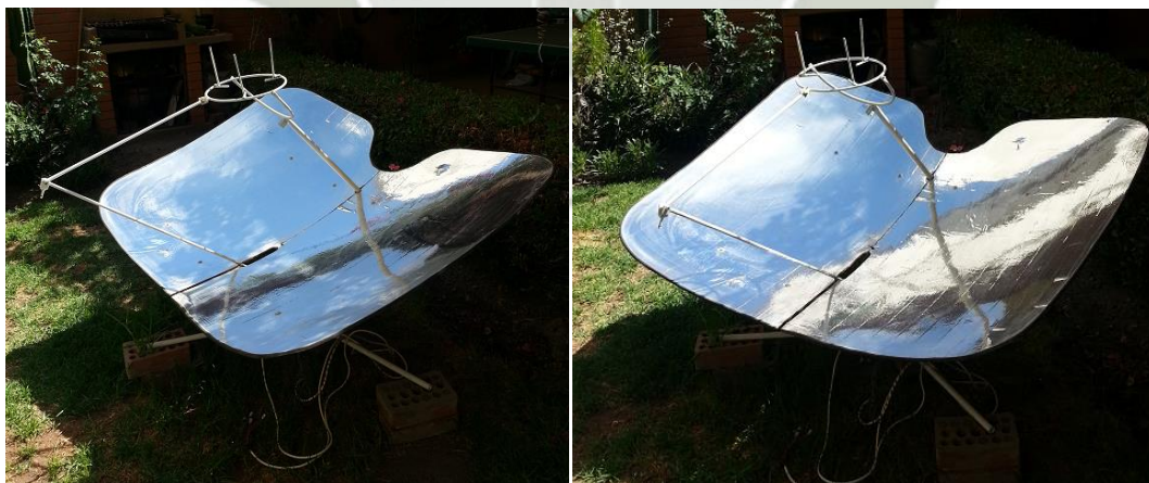
Fig. 4.1 Alineación Automática del Plato Reflector Solar
