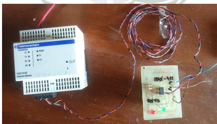
Fig. 3.37 Convertidor RS-485 a Ethernet TSXETG100 ConneXium
