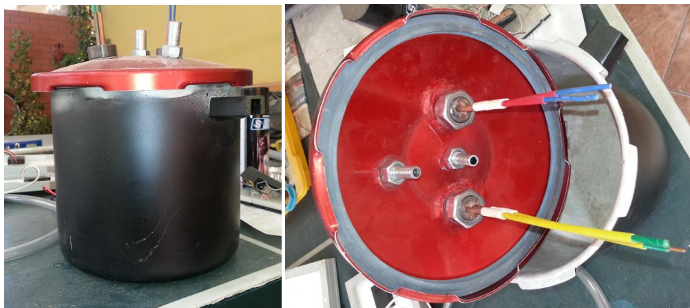
Fig. 3.75 Olla Solar diseñada a partir de Olla a Presión
