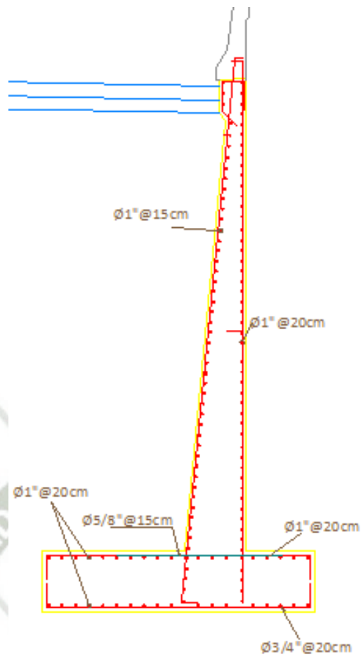
Figura 7.12 Distribución de Acero Muro De Contención
