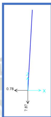
Figura 4.11 Dirección de las fuerzas resultantes a un ángulo de 45°
