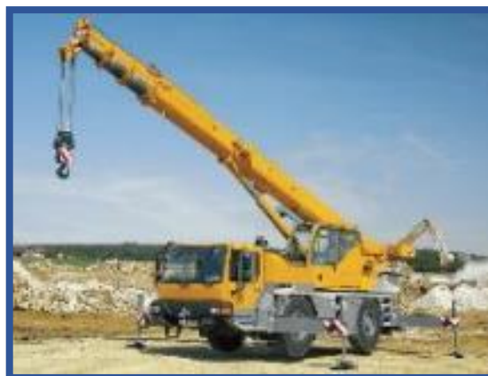
Figura 2.1 Grúa telescópica 35 toneladas
