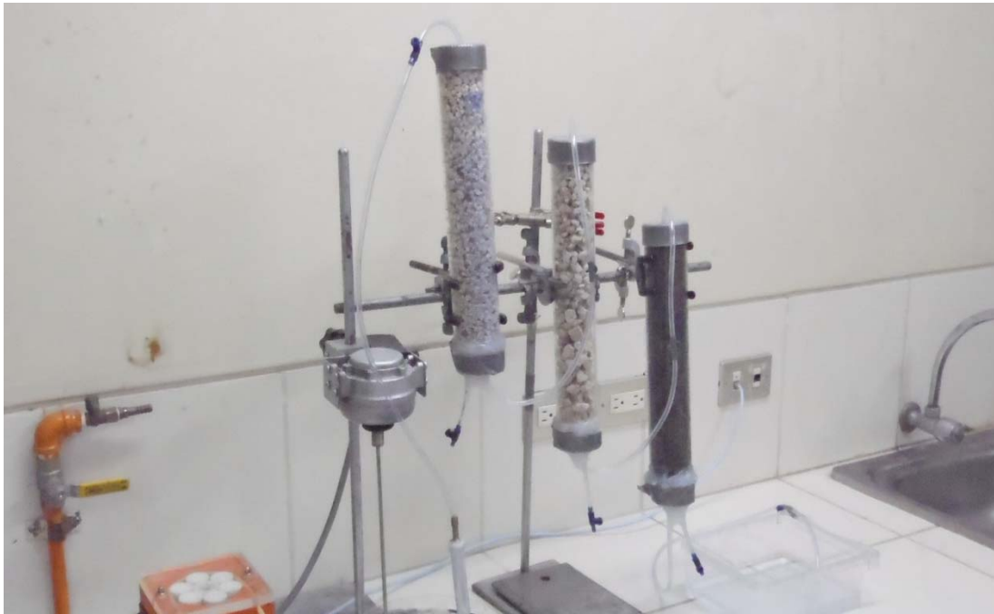
Figura 87. Sistema de remoción de Plomo (II) y Cadmio (II).
