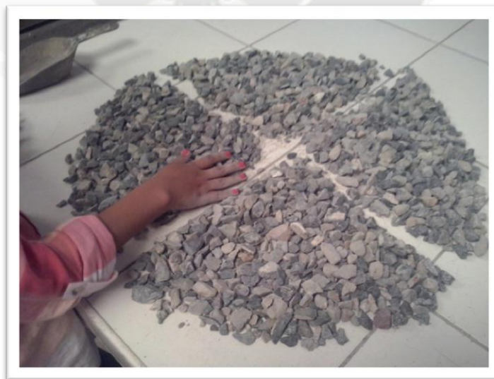
Figura 3.19 Cuarteo del agregado grueso.
