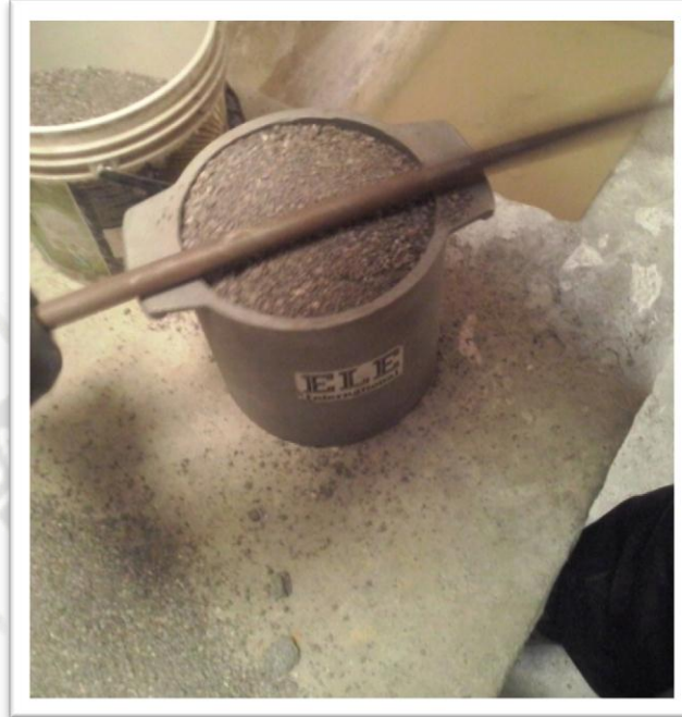
Figura 3.6. Procedimiento: Haga rebosar el Agr. Fino y use la barra como regla para eliminar el material rebosante.
