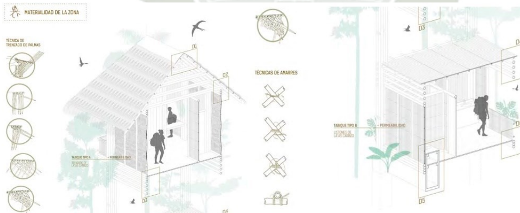
Figura 23 Sistema constructivo: vivienda – técnicas de la zona.
