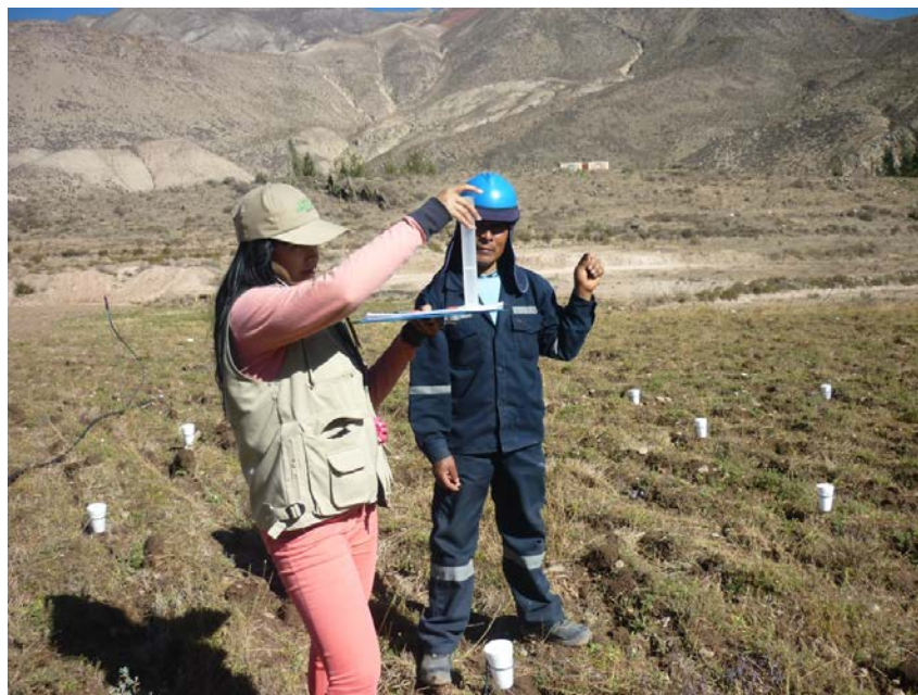
FOTOGRAFÍA 33. Medición de la pluviometría con probeta graduada (Chipicpita)
