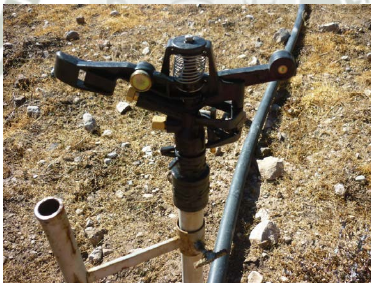
FOTOGRAFÍA 32. Aspensor sectorial de impacto plástico 2 boquillas empleado en Sector Chipicpita
