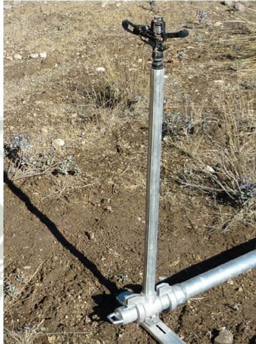
FOTOGRAFÍA 12. Tubería de aluminio 2", elevador \frac{3}{4} " y aspersor plástico (Staff)
