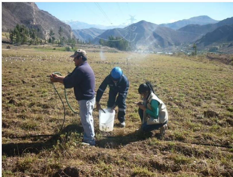
FOTOGRAFÍA 26. Medición de la descarga de un aspersor (Sector La Ponderosa)
