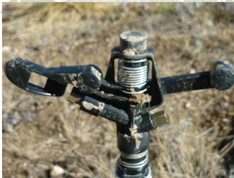
FOTOGRAFÍA 12. Tubería de aluminio 2", elevador \frac{3}{4} " y aspersor plástico (Staff)
