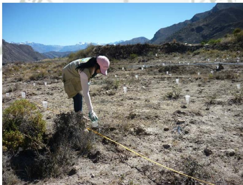
FOTOGRAFÍA 16. Medición de espaciamientos de los pluviómetros (Sector Staff)
