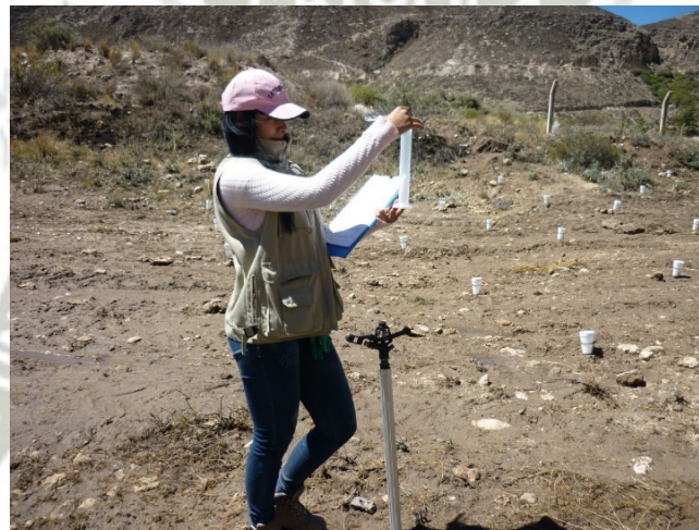
FOTOGRAFÍA 19. Medición del agua caída en los pluviómetros (Sector Staff).
