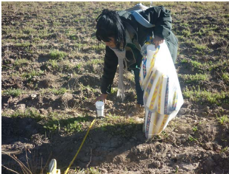
FOTOGRAFÍA 22. Colocación de pluviómetros en campo (Sector La Ponderosa)
