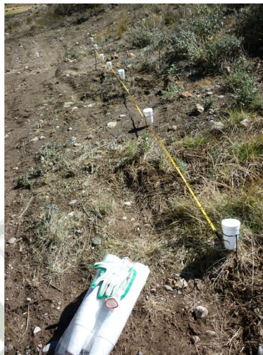
FOTOGRAFÍA 16. Medición de espaciamientos de los pluviómetros (Sector Staff)
