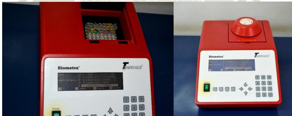
Figura 47.- Muestras colocadas en termociclador y programadas según los tiempos y temperaturas indicados.
