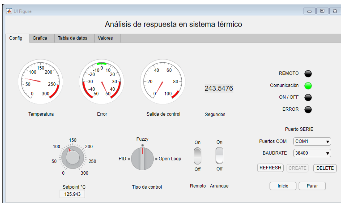
Fig. 73 Pantalla de configuración y visualización de sistemas térmicos Fuente: Elaboración propia
