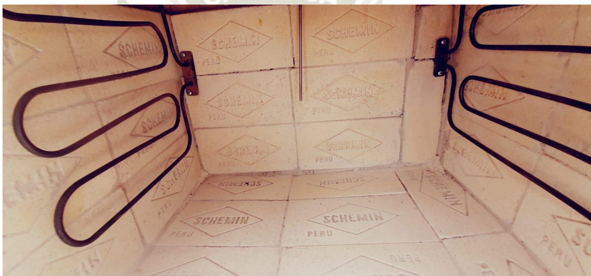
Fig. 65 Interior de cámara de calor en horno eléctrico Fuente: Elaboración propia
