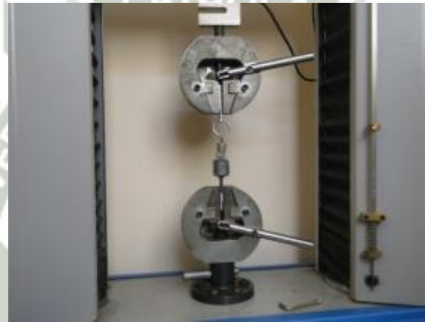
COLOCACION DEL LOS ADITAMENTOS PARA LA TRACCION
