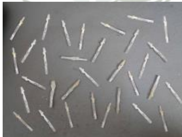
PERNOS DE FIBRA DE VIDRIO DESPUES DE SER SOMETIDOS A LA TRACCION
