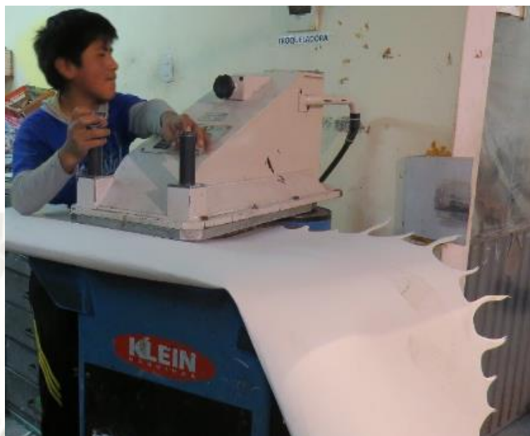
Figura 53. Sistema de troquelado
