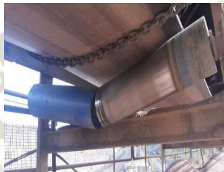
Figura 26. Reposición de Polines Fuente: Elaboración propia
