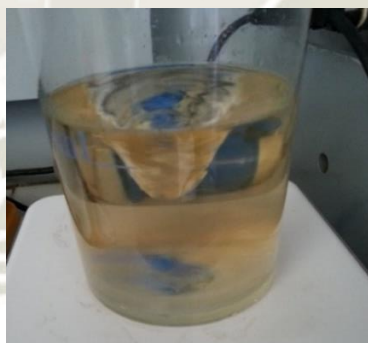
Figura N° 40: Mezcla de Lactida más alcohol metílico en agitación magnética.
