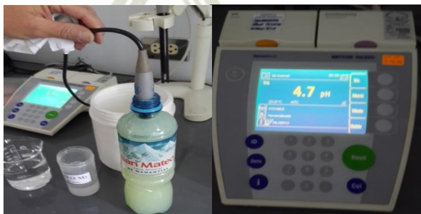
Figura N° 24: Medición de pH de la muestra de Ácido Láctico para la fermentación de S. aureus .
