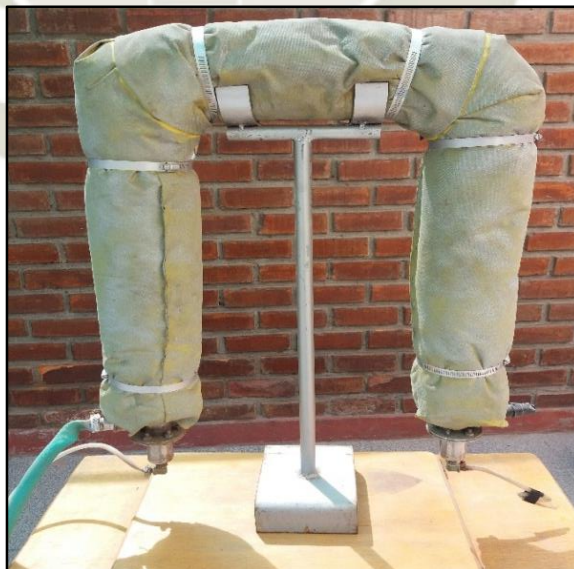
Figura N° 22: Biorreactor PFTR– Flujo pistón
