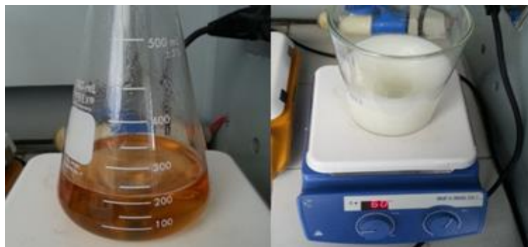
Figura N° 41: A la izquierda formación de la coloración Cajeta con aroma acaramelada y a la derecha mezcla de Lactida + Alcohol Metílico + Cloruro de Estaño II.
