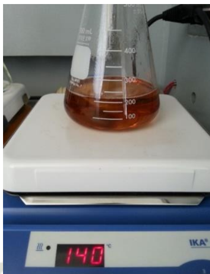
Figura N° 29: Matraz que contiene Lactida de coloración caramelo oscuro
