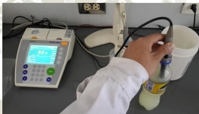
Figura N° 23: Medición del pH de la muestra de ácido Láctico para la fermentación de L. casei
