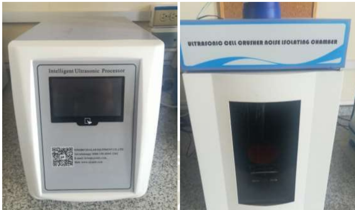
Figura 37y 38: Equipo de Ultrasonido “Ultrasonic Cell Crusher Noise Isolation Chamber”. Fuente: Propia
