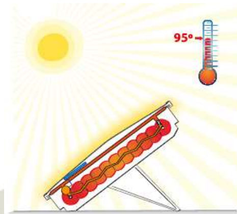
Figura 20: Transferencia de calor del fluido caloportador al depósito.
