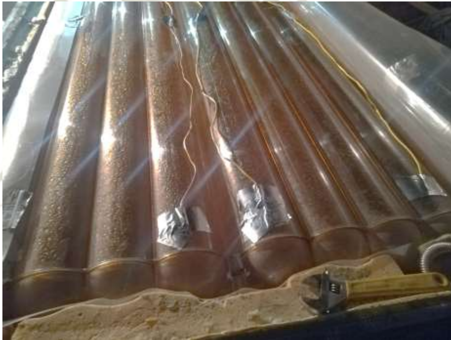
Figura 26: Instalación de los termopares en el depósito del colector
