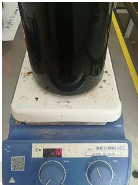
Figura 34: Mezcla de nanotubos de carbono con agua destilada usando un agitador magnético. Fuente: Propia.
