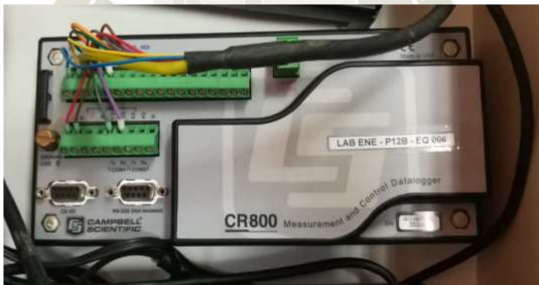
Figura 25: Adquisidor de Datos CR800 Datalogger. Fuente: Propia
