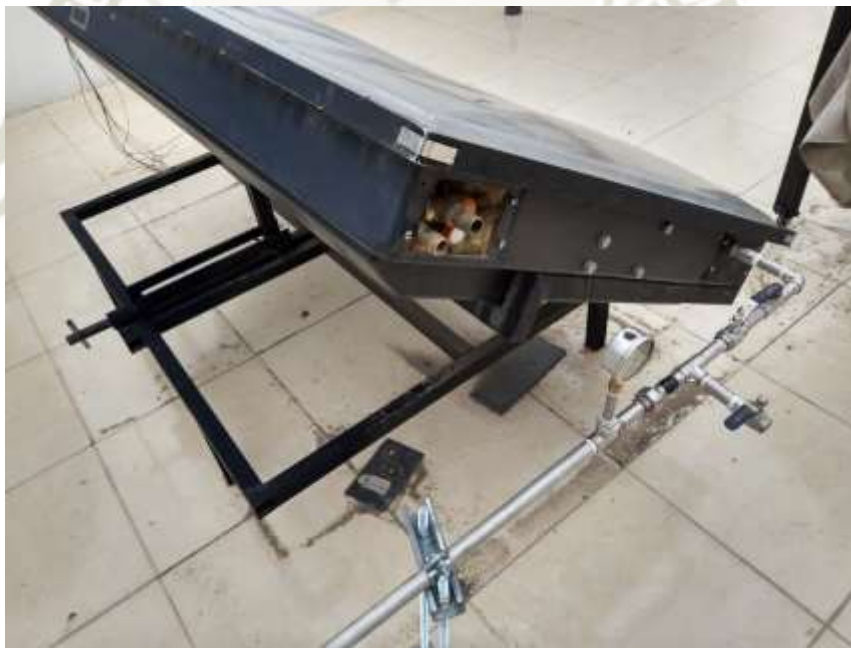
Figura 29: Colector solar instalado (Vista Lateral) Fuente: Propia
