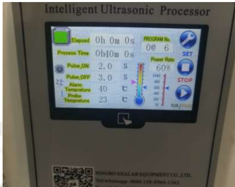
Figura 41: Parámetros para el equipo de ultrasonido. Fuente: Propia
