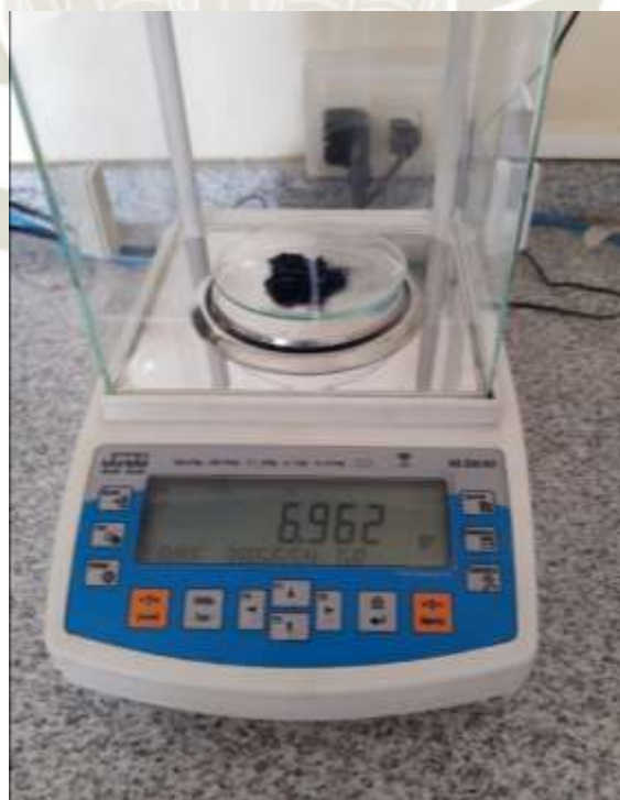
Figura 36: Nanotubos de Carbono para preparar nanofluido con tratamiento químico y físico a 0.1% de concentración en volumen para 4 litros. Fuente: Propia
