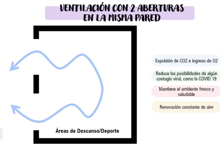
Figura 75: Ventilación con 2 aberturas
