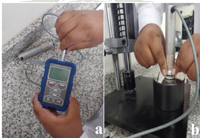
Figura 3.16 Conexión (a) y sujeción (b) de la sonda de 50 \text{ N} Fuente: Elaboración propia
