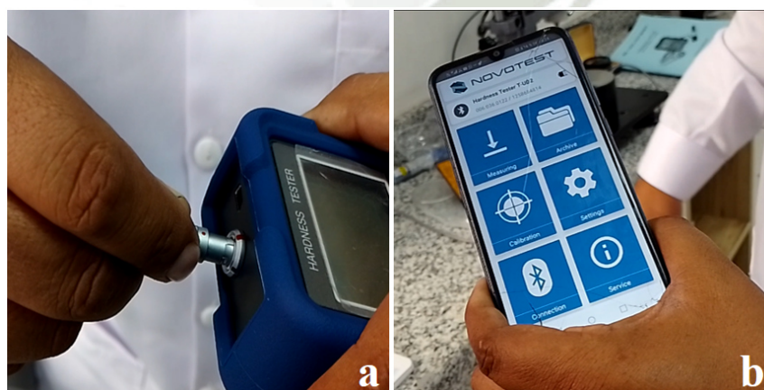
Figura 3.9 Conexión (a) y operación remota del equipo NOVOTEST T-UD2 (b) Fuente: Elaboración propia
