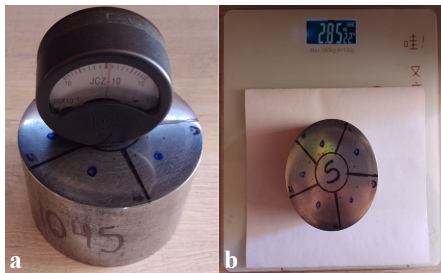
Figura 3.8 Preparación de la probeta de prueba AISI 1045 Fuente: Elaboración propia
