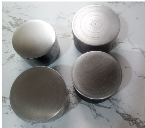
Figura 1.4 Probetas preparadas para la prueba de dureza Leeb Fuente: Elaboración propia
