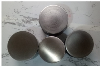
Figura 1.10 Probetas preparadas para la prueba de dureza UCI Fuente: Elaboración propia
