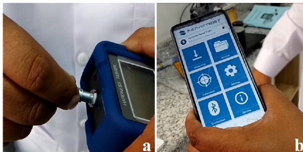
Figura 1.5 Conexión y operación remota del equipo NOVOTEST T-UD2 Fuente: Elaboración propia
