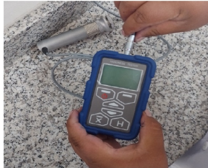
Figura 1.11 Probetas preparadas para la prueba de dureza UCI Fuente: Elaboración propia
