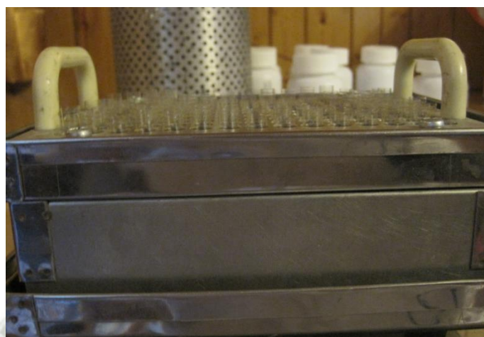
Figura N°3: Encápsuladora manual de acero inoxidable (construcción artesanal)
