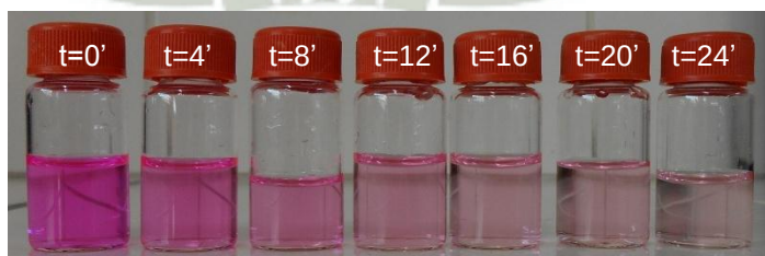
Fig. 3.40. Cambio en la coloración de la Rodamina B a diferentes tiempos, luego de aplicar la fotocátalisis.
