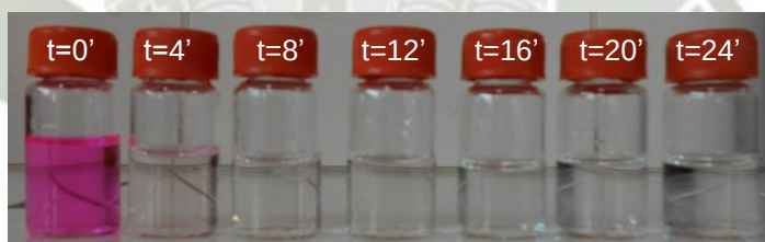
Fig. 3.49. Cambio en la coloración de la Rodamina B a diferentes tiempos, luego de aplicar la fotocatalisis.
