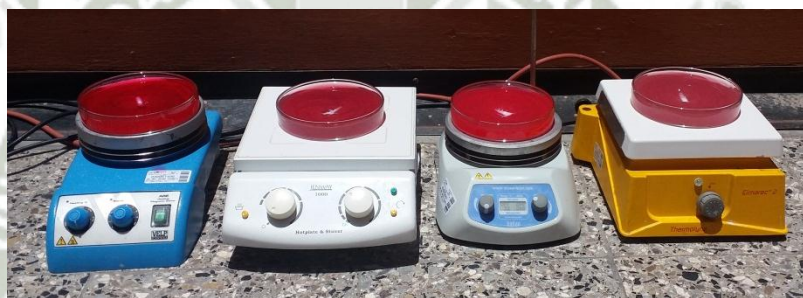
Fig. 2.4. Reactores agitados magnéticamente bajo radiación solar.
