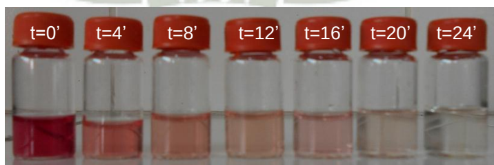
Fig. 3.31. Cambio en la coloración del colorante a distintos intervalos de tiempo, después de aplicar el proceso de fotocátalisis.
