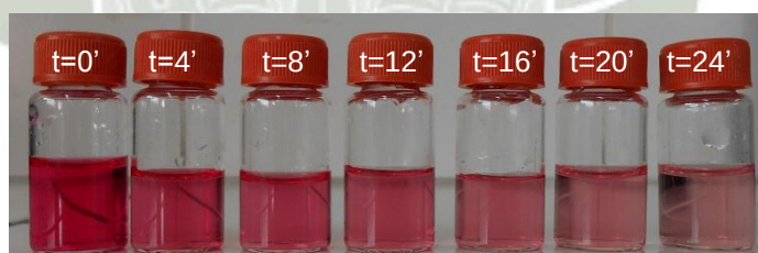
Fig. 3.34. Cambio en la coloración del Ácido Carmínico a diferentes tiempos, después de aplicar la fotocátalisis.
