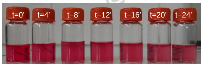
Fig. 3.28. Cambio en la coloración del colorante a distintos intervalos de tiempo, después de aplicar el proceso de fotocatalisis.
