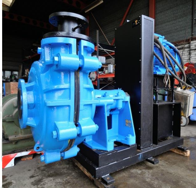
Gráfica 29: Bomba para slurry con liner interior acoplada mediante faja de 8x6.
