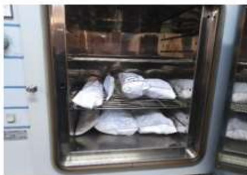
Secado de las muestras en la estufa
