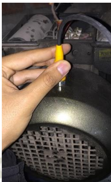
Figura 107: Medición en posición vertical del motor 2HP
