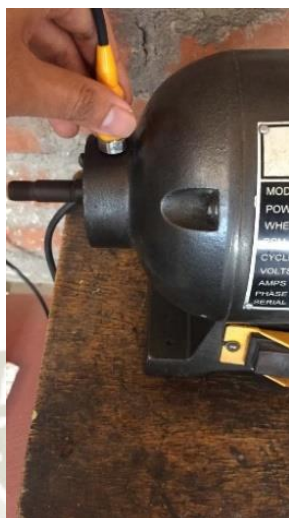
Figura 97: Medición de la zona 1 del motor de 0.5HP
