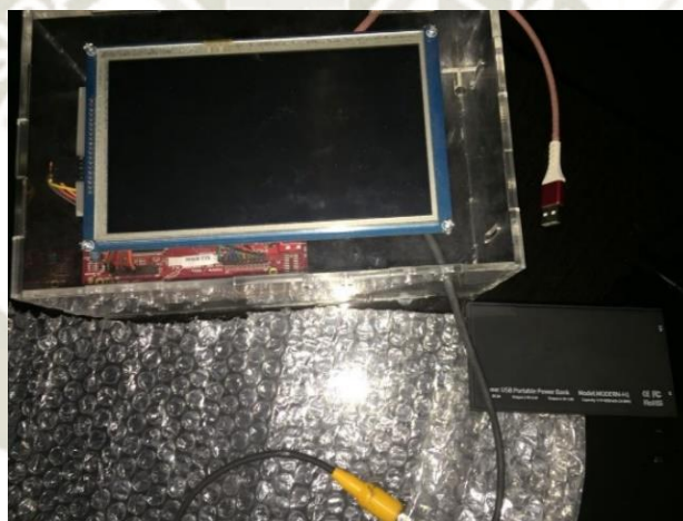
Figura 90: Equipo prototipo del registrador de vibraciones
