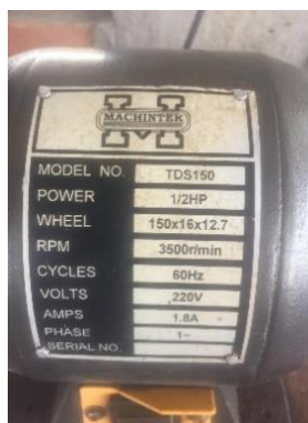
Figura 96: Placa de características del motor 0.5HP
