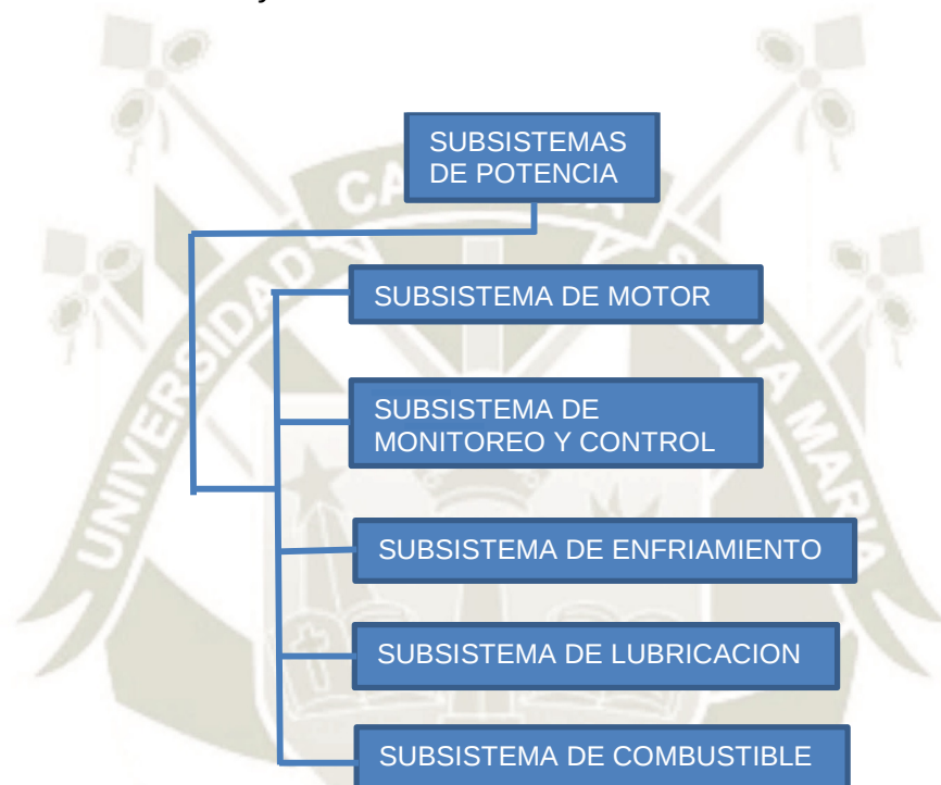
Figura 31: Diagrama de sub-sistemas de potencia de freightliner CL120. Fuente: Elaboración propia.
