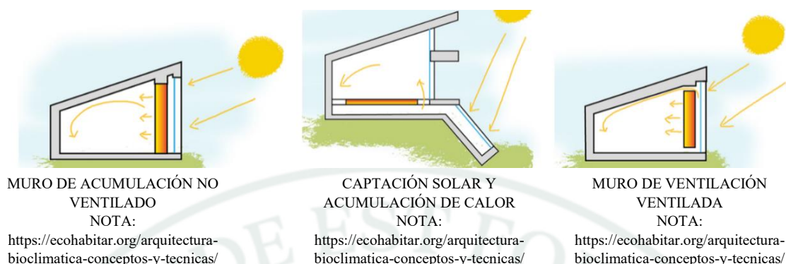
Figura 13 Sistemas pasivos indirectos de captación solar
