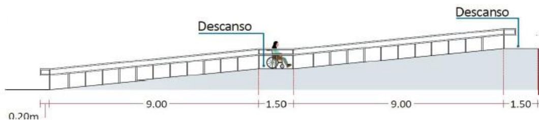
Figura 60 Características de diseño en rampas y escaleras 2
