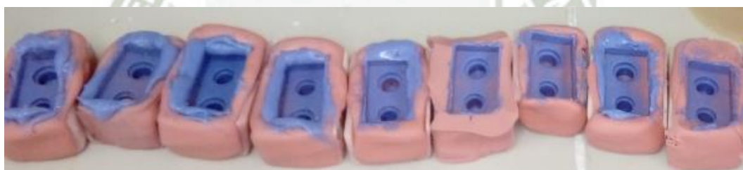
Foto 5. Impresiones del patrón metálico (TOMA 2) Silicona de condensación silaxil fluida
