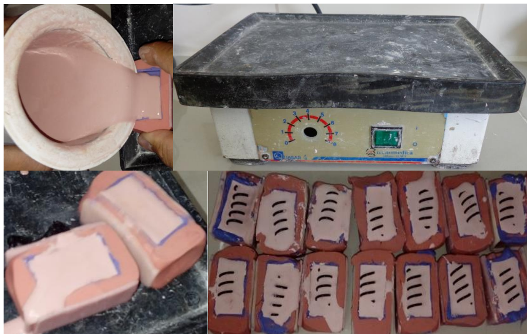
Foto 6. Vaciado de las impresiones definitivas con yeso Velmix Tipo IV
