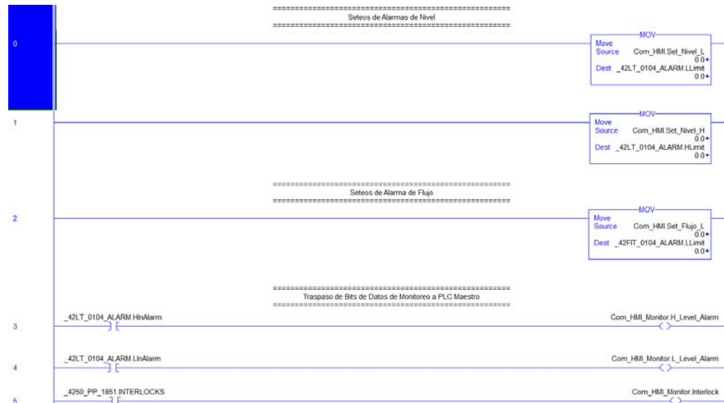
Figura N°64. Rutina donde se escriben los valores seteados en PanelView
