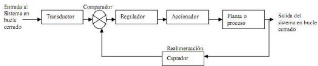
Figura N°4. Componentes de un sistema de control
