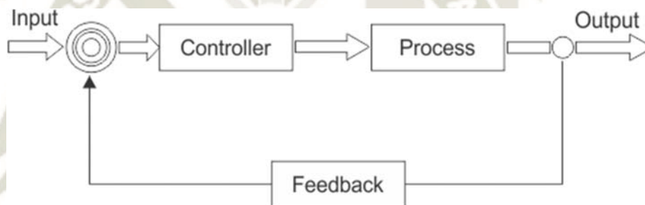
Figura N°3. Sistema de control de lazo cerrado
