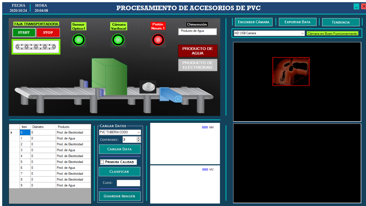
Figura 5.3 Control de calidad mediante VA en tubo codo para agua
