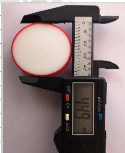
Figura 5.14 Comparación de medidas en envases pequeños (producto defectuoso)
