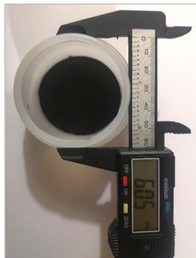
Figura 5.12 Comparación de medidas en envases grandes (producto defectuoso)
