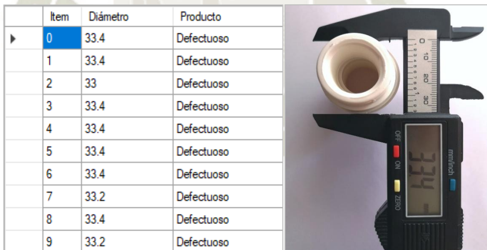
Figura 5.16 Comparación de medidas en unión universal de tuberías (producto defectuoso)
