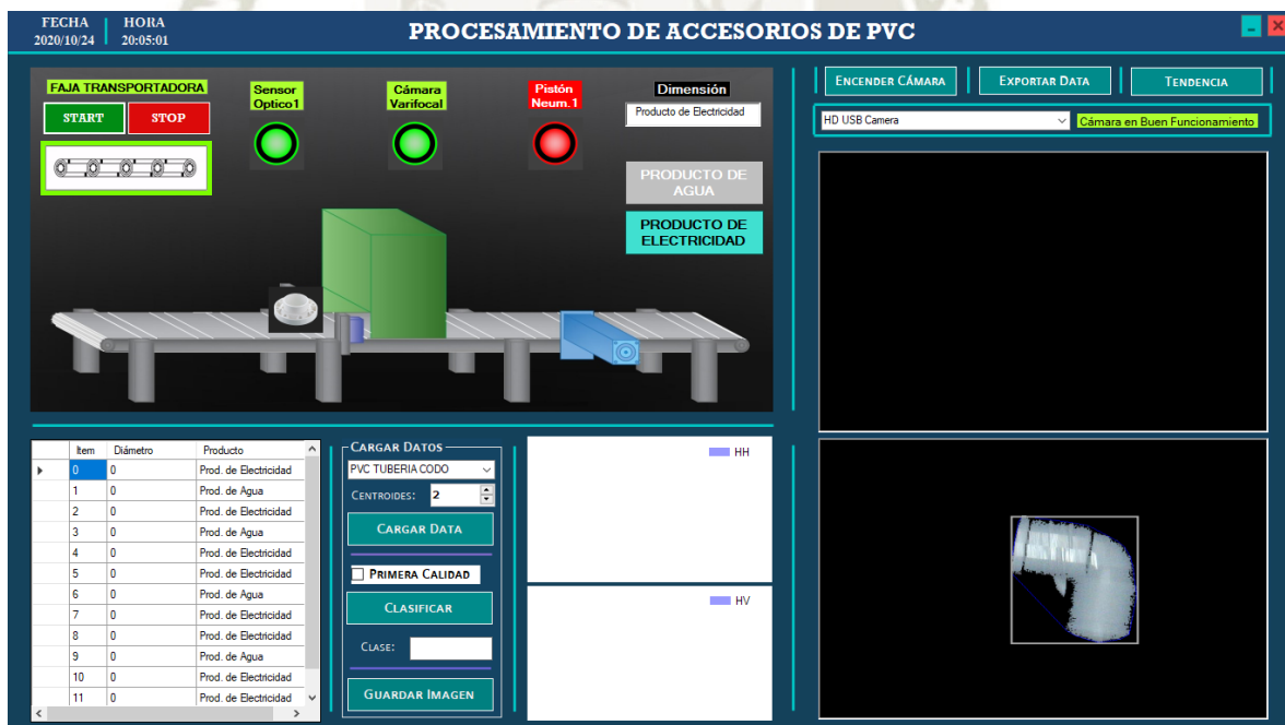
Figura 5.4 Control de calidad mediante VA en tubo codo para electricidad
