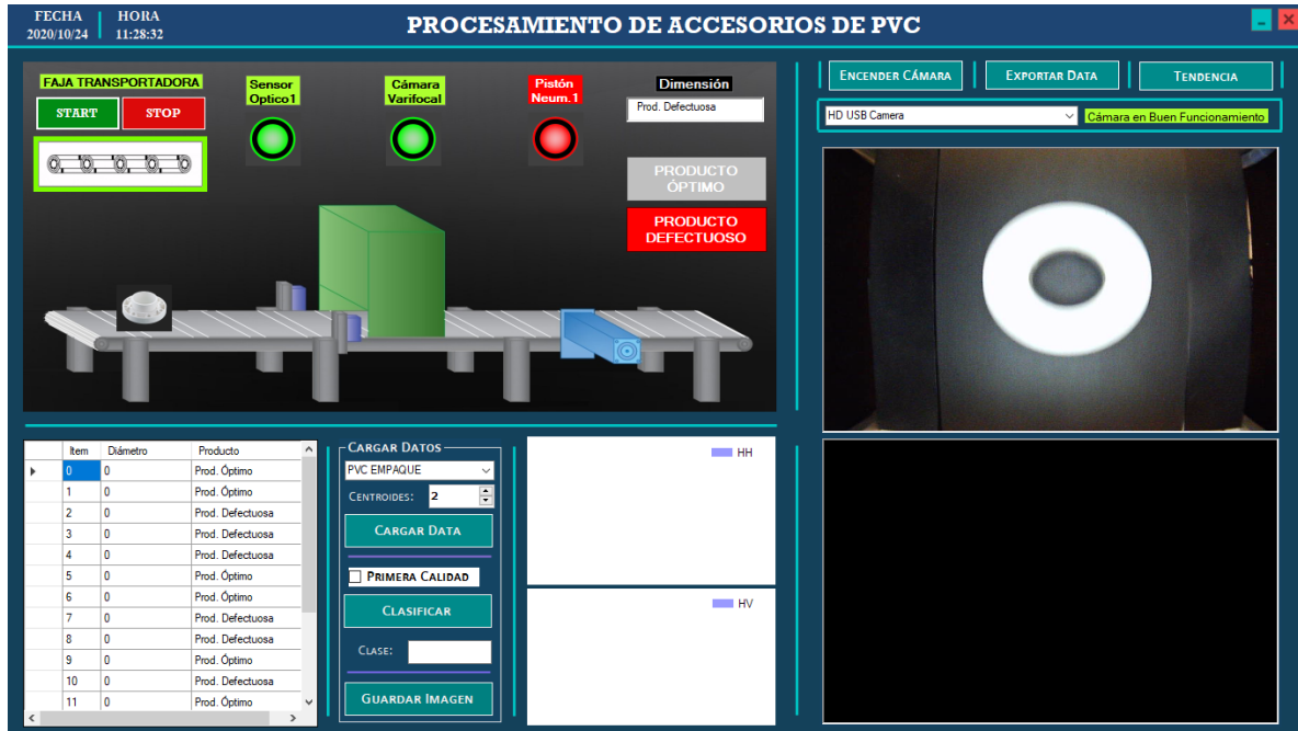
Figura 5.2 Control de calidad mediante VA en empaques (producto defectuoso)
