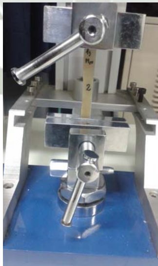
Figura 3.4: Montaje de probetas durante el ensayo de tracción.
