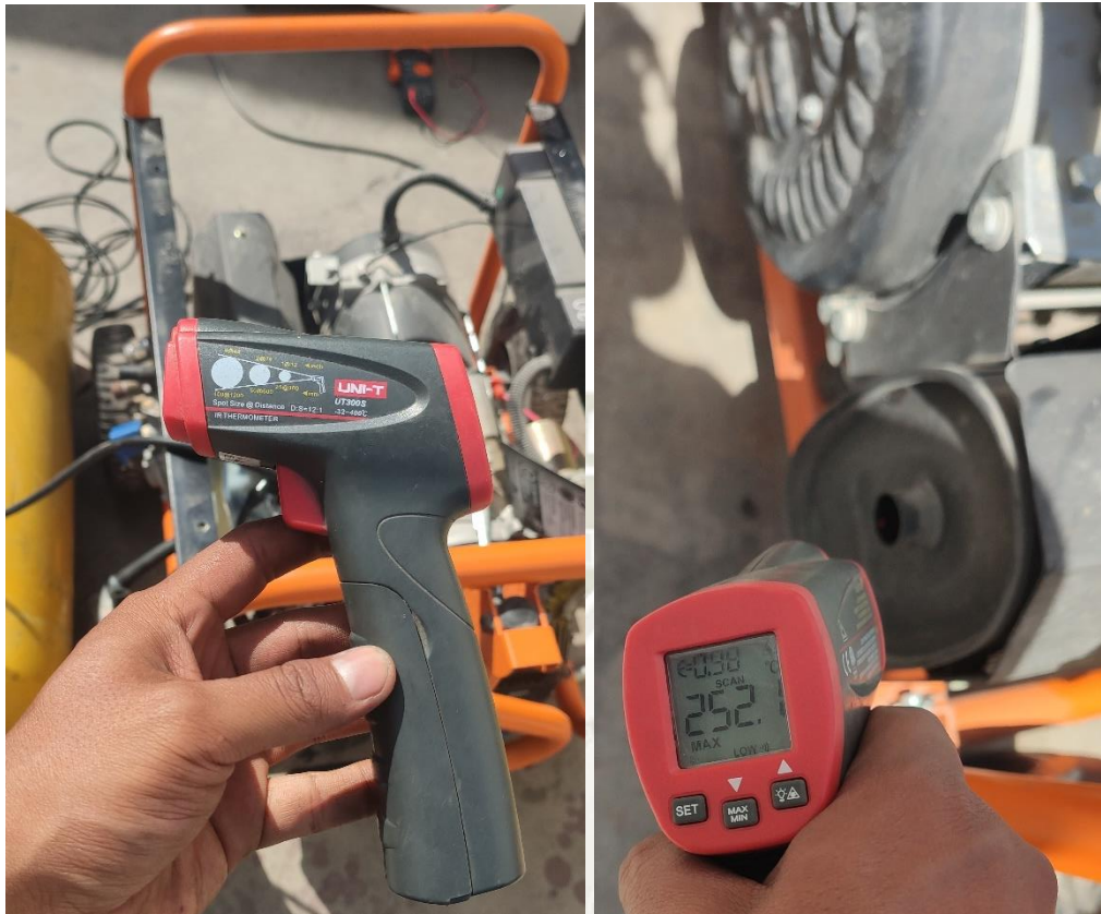
FOTO 6: MEDICIÓN TEMPERATURA DE ESCAPE DE MOTOR
