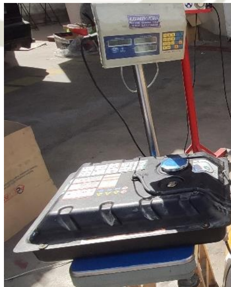
Figura 25: Balanza para medir el peso que se consume por minuto
