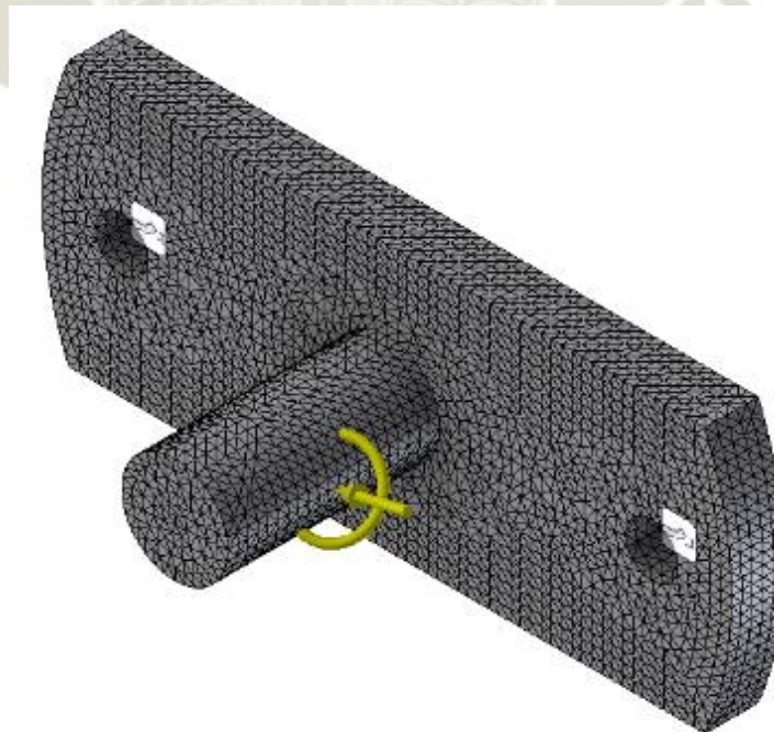
Figura 37. Mallado de la corredera. Fuente: Inventor, 2019.
