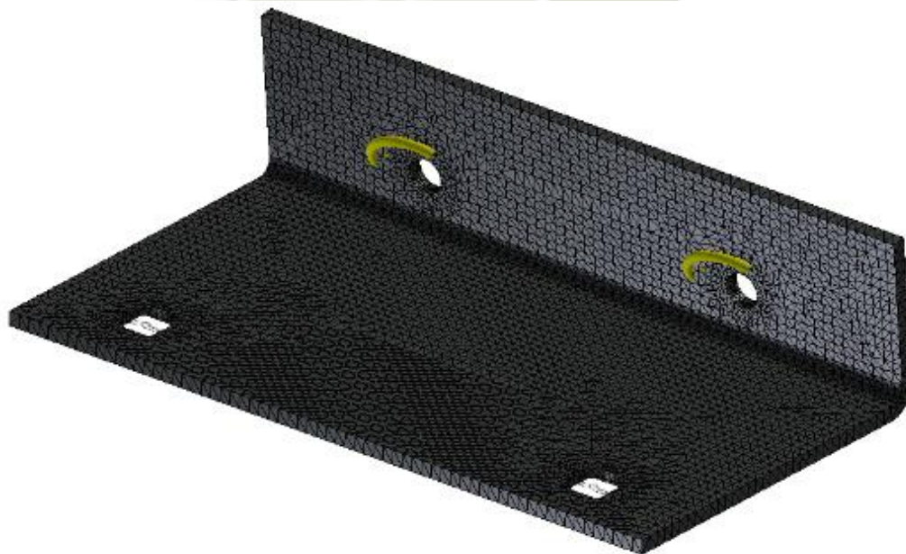
Figura 40. Mallado de la plancha de sujeción. Fuente: Inventor, 2019.
