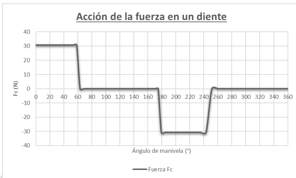
Figura 21. Gráfico de acción de la fuerza en un diente. Fuente: Propia.
