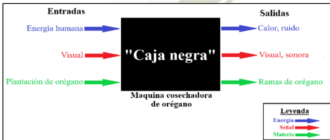
Figura 12. Diagrama de caja negra para máquina cosechadora de orégano. Fuente: Propia.
