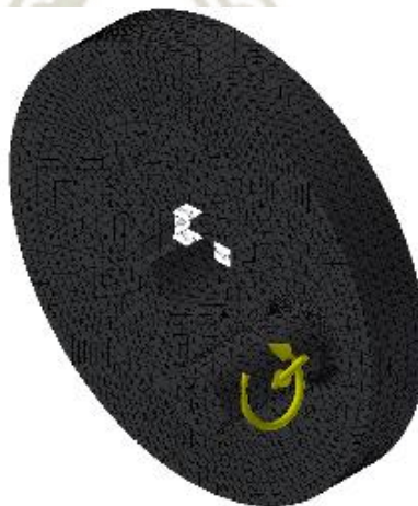
Figura 31. Mallado de la manivela. Fuente: Inventor, 2019.
