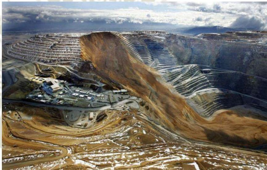
Imagen 3. deslizamiento en mina Kennecott Utah Copper (Foto: KSL.com)
