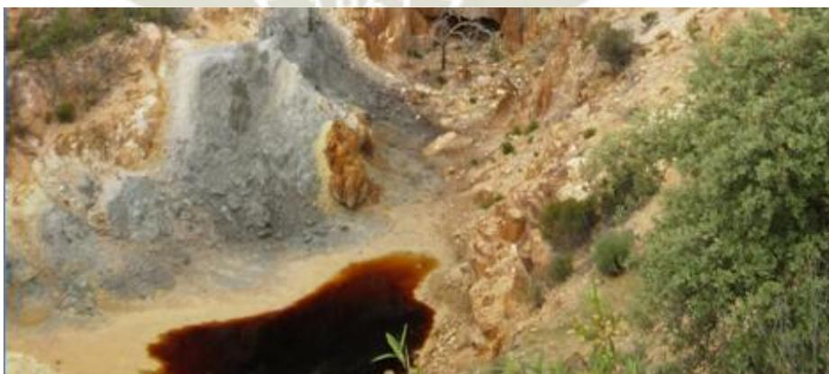
Imagen 4. masa de sulfuros expuesta a las condiciones atmosféricas de forma artificial, por la apertura de una trinchera de explotación. Mina el Soldado (Fuente: AMAyA)
