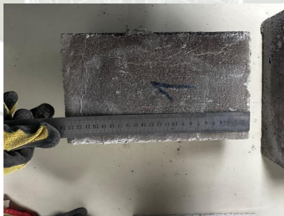
Ilustración 25. Ensayo de variación de dimensiones en muestra 1
