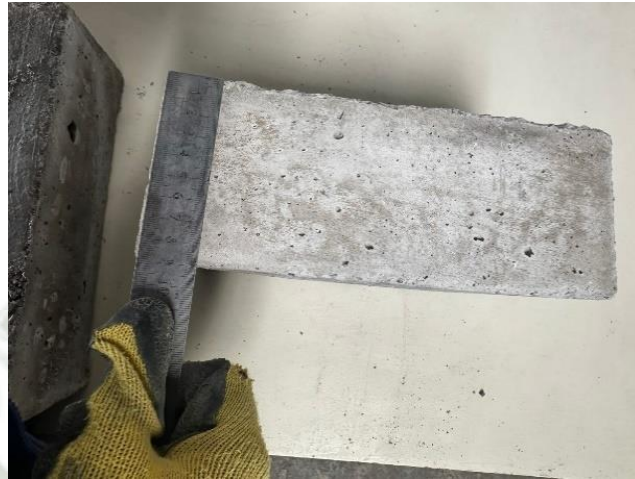
Ilustración 26. Ensayo de variación de dimensiones en muestra 1
