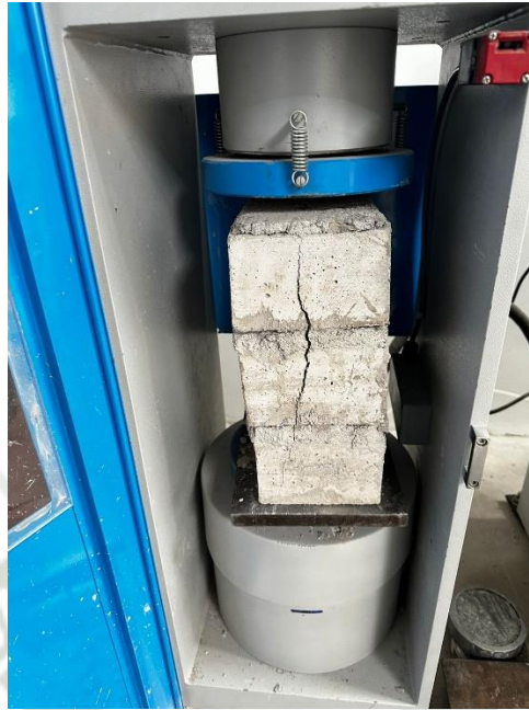
Ilustración 28. Ensayo de compresión de pilas .Dosificación Tipo 1
