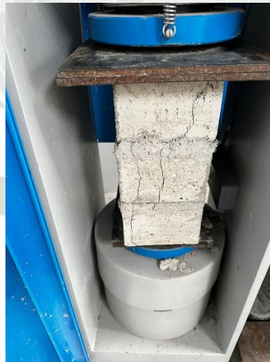
Ilustración 29. Ensayo de compresión de pilas. Dosificación Tipo 2
