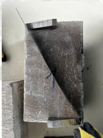
Ilustración 27. Ensayo de alabeo en muestra 1
