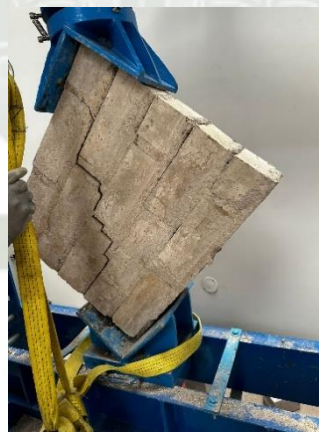
Ilustración 33. Ensayo de compresión de muretes. Dosificación 1, Mortero 1:4
