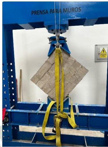
Ilustración 32. Ensayo de compresión de muretes. Dosificación 1, Mortero 1:4
