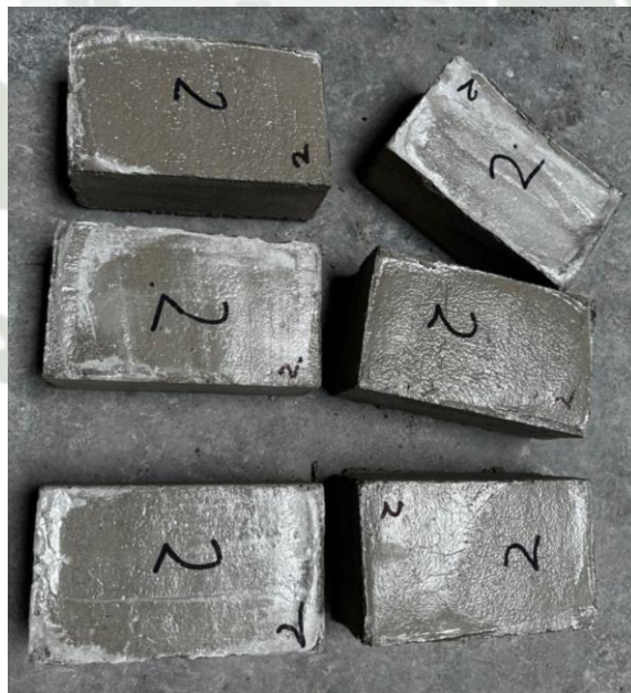
Ilustración 21. Ecoladrillo diseño 2 Segunda dosificación. Cemento 25%, HDPE 7.5%, PET 47.5%, A gruesa 15%
