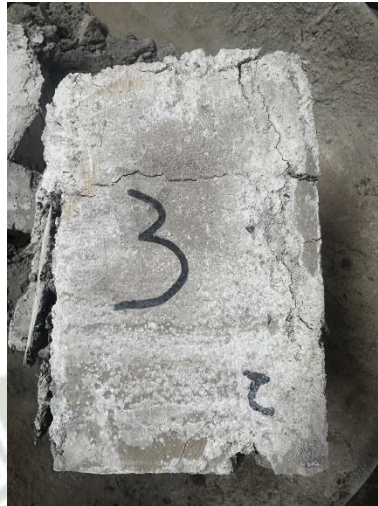
Ilustración 20. Ecoladrillos después del ensayo de resistencia a 7 días (Segunda dosificación 3)
