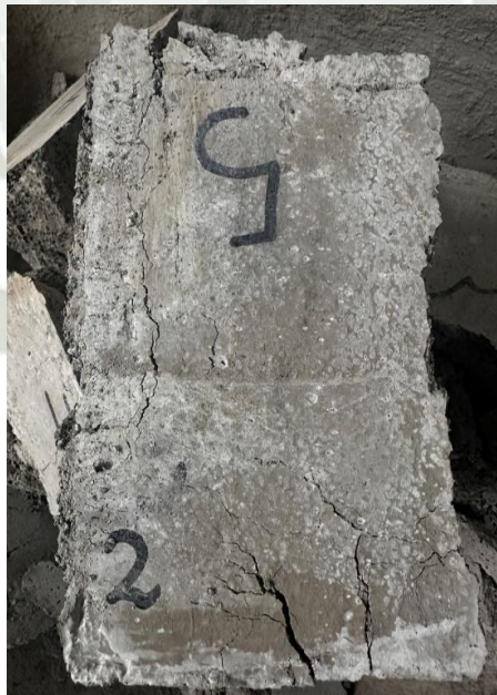
Ilustración 19. Ecoladrillos después del ensayo de resistencia a 7 días (Segunda dosificación 5)
