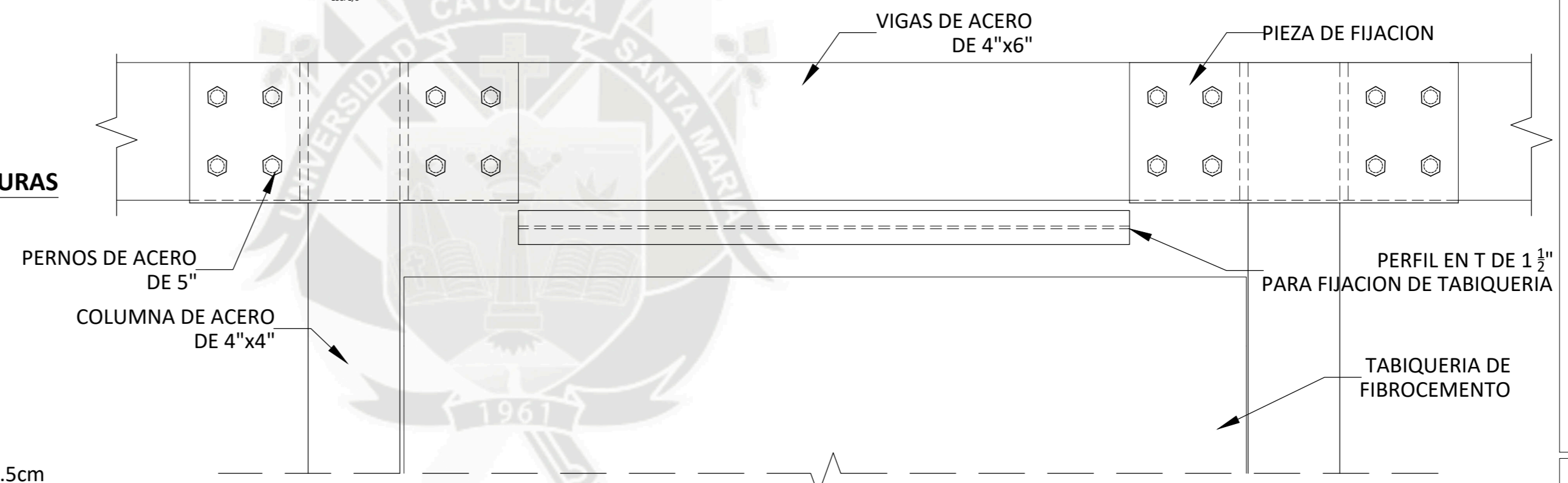
◦ DETALLE ENCUENTRO TABIQUE Y ESTRUCTURA ESC. 1/5
