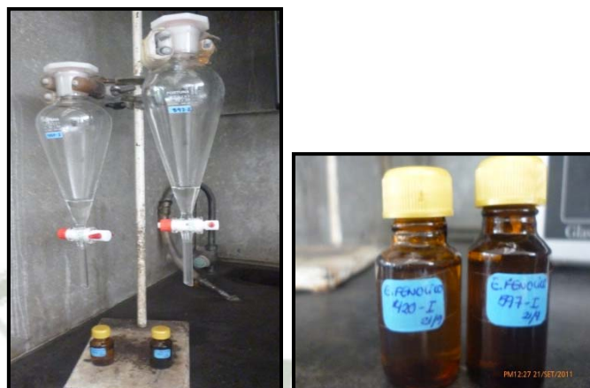
Figura N°16. Fotografías del procedimiento de extracción de los compuestos fenólicos.
