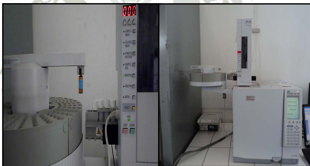
Figura N°18. Fotografías del procedimiento de corrida de Fitoesteroles en el Cromatografo de Gases, CG-2010 PLUS.
