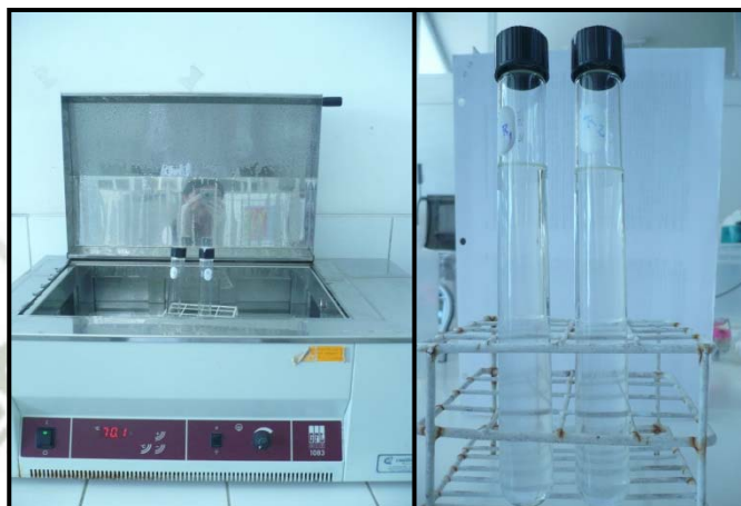
Figura N°20. Fotografía del procedimiento de metilación y extracción de los Ácidos grasos.
