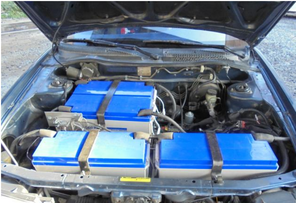
Fig. 4 Sistema eléctrico instalado en vehículo convertido (Arequipa-2015)
