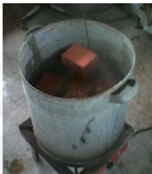
Fig. 21 Reposo de ladrillos en agua hirviendo.
