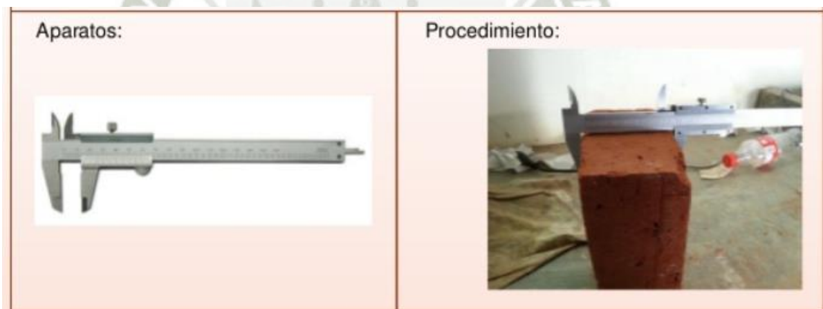
Fig. 14. Determinación de dimensiones
