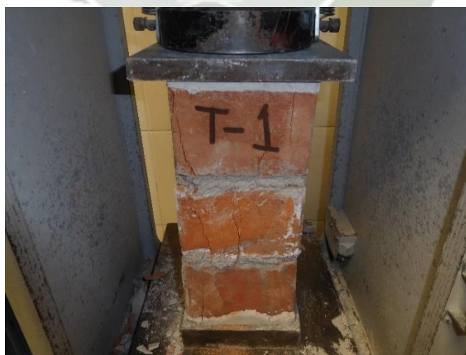
Fig. 26 Ensayo de Pilas Ladrillera Tauro
