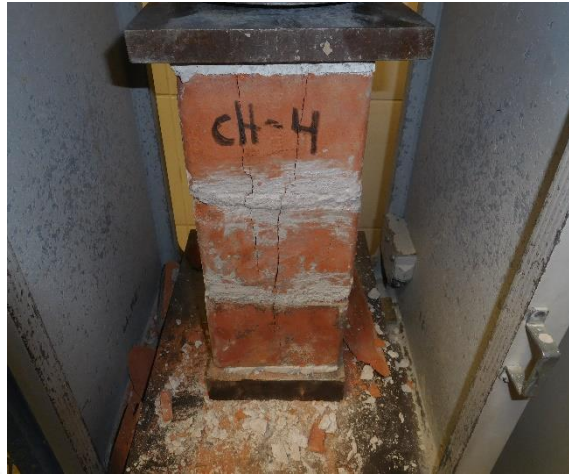
Fig. 24 Ensayo de Pilas Ladrillera Choque
