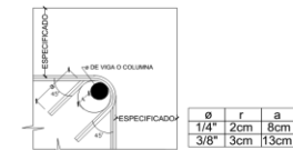
DETALLE DOBLADO ESTRIBOS EN COLUMNAS O VIGAS
