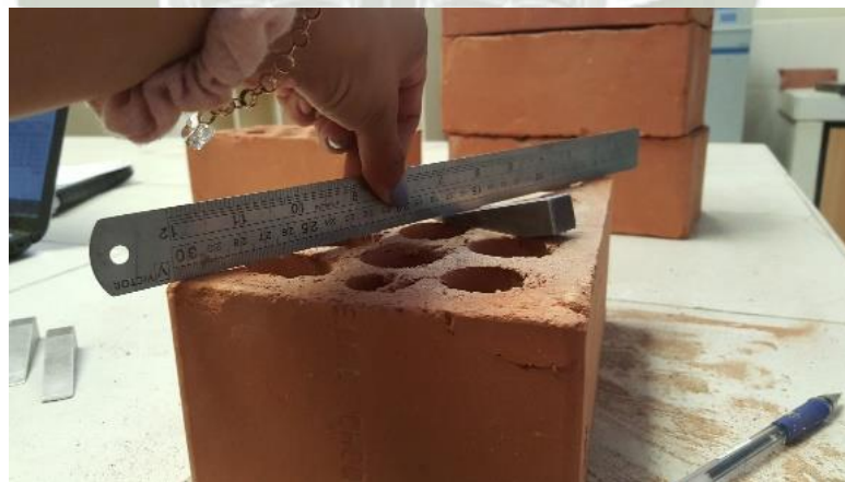
Fig. 17. Medición de la concavidad
