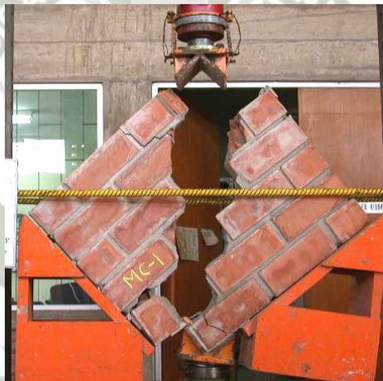
Fig. 29 Ensayo a compresión Diagonal falla es escalonada a través de las juntas.
