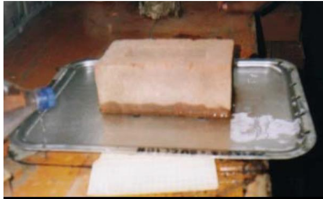
Fig. 12. Ensayo de succión de la unidad de albañilería
