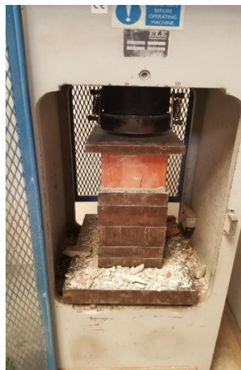
Fig. 10. Ensayos a compresión
