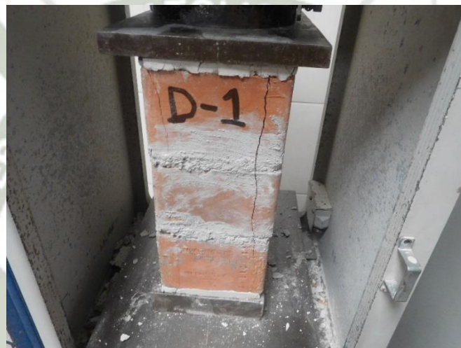
Fig. 25 Ensayo de Pilas Ladrillera Diamante
