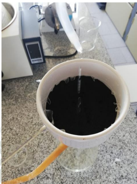
Figura 3. 10. Lavado y filtrado de resina a regenerar
