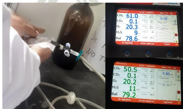
Determinación de calidad de biogás en el equipo (Biogás 5000 GEOTECH, UCSM)
